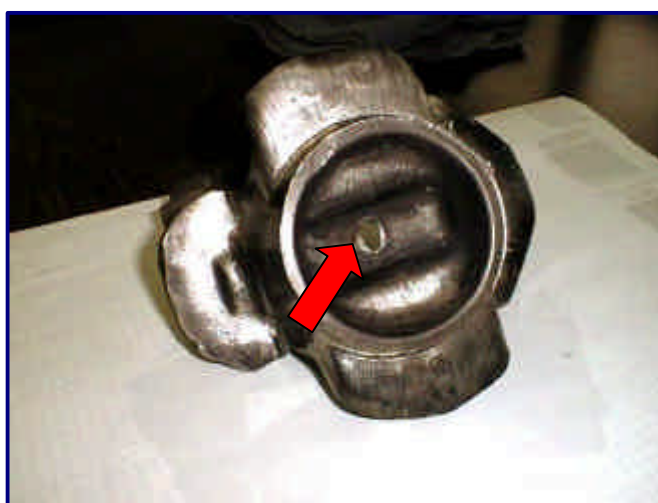
Figura 61 Aspecto do Garfo forjado em alumínio – Dana DFR
