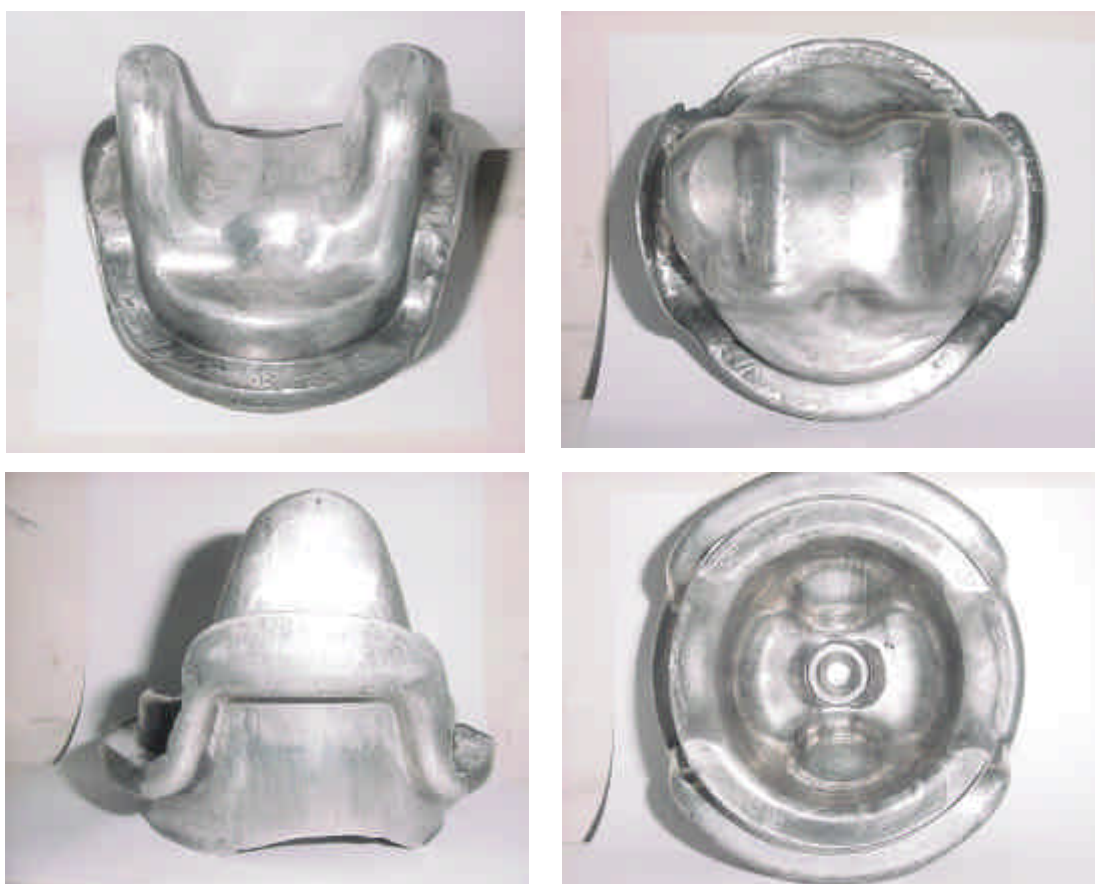
Figura 66 Peça forjada com rebarba – LdTM-UFRGS
