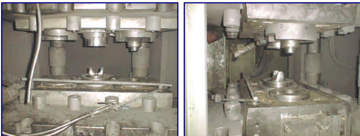
Figura 68 Detalhe do ferramental e a 1 o peça forjada no teste
