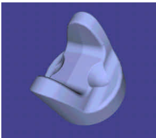
Figura 52 peça forjada "F3-28-409" Fonte: Dana
