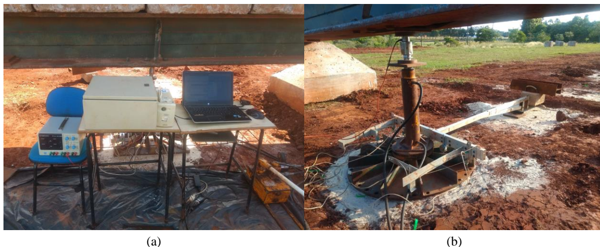
Figura 4.10: Configuração final do ensaio: (a) sistema de aquisição; (b) instrumentação.
