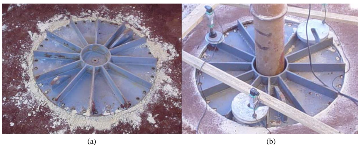
Figura 3.16: Instalação da placa de ensaio com a aplicação de camada niveladora de areia. (b) Ruptura por puncionamento observada. Adaptado de Dalla Rosa & Thomé (2004).
