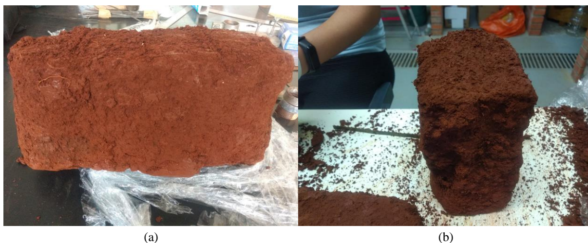
Figura 4.11: Processo de moldagem das amostras indeformadas: (a) bloco indeformado; (b) seccionamento em blocos menores;
