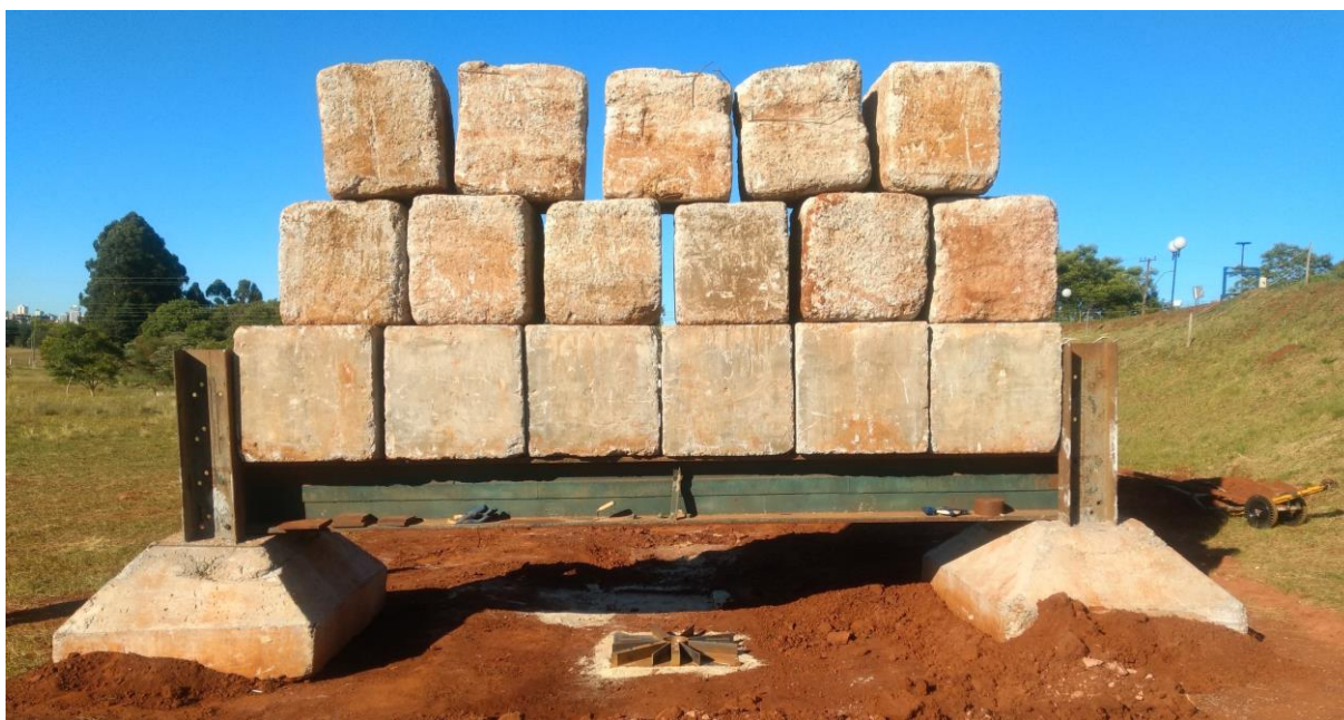
Figura 4.5: Sistema de reação empregado nos ensaios.
