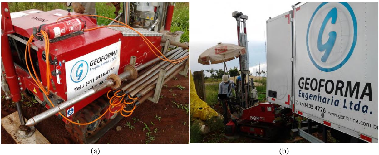
Figura 3.11: Equipamento utilizado: (a) cone elétrico; e (b) equipamento de cravação (FARO, 2014).
