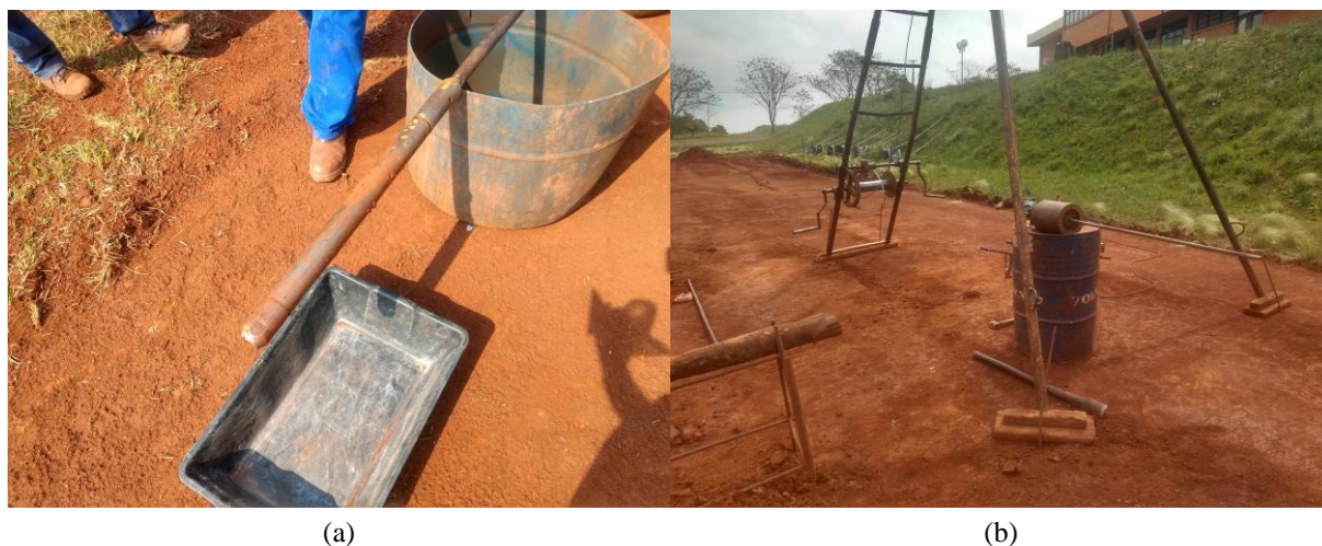
Figura 4.3: Equipamento utilizado: (a) amostrador; e (b) equipamento de cravação.
