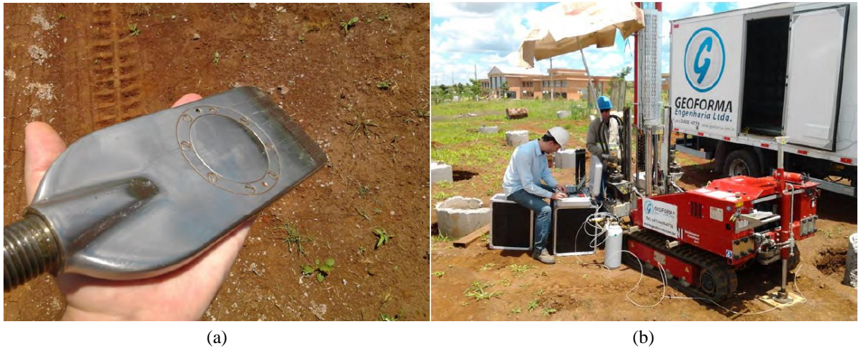
Figura 3.13: Equipamento utilizado: (a) dilatômetro; e (b) equipamento de cravação (FARO, 2014).
