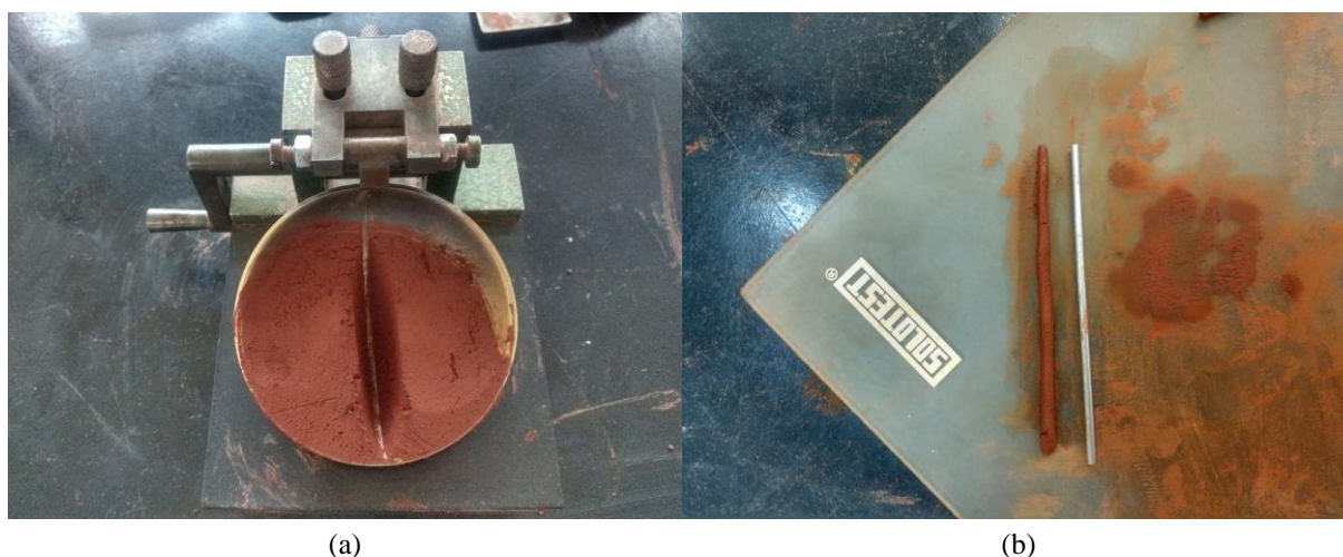
Figura 4.13: Instrumentos utilizados para a realização do ensaio de limites de consistência: (a) aparelho de Casagrande; (b) placa de vidro e barra metálica de referência.
