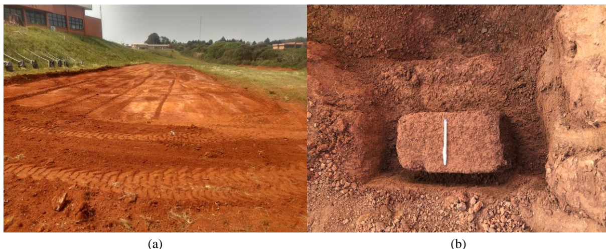
Figura 4.4: Coleta de amostras: (a) local dos ensaios e da extração das amostras; (b) extração do bloco indeformado.
