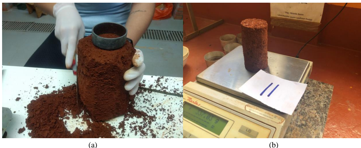
Figura 4.12: Processo de moldagem das amostras indeformadas: (a) processo de talhagem; (b) amostra final.
