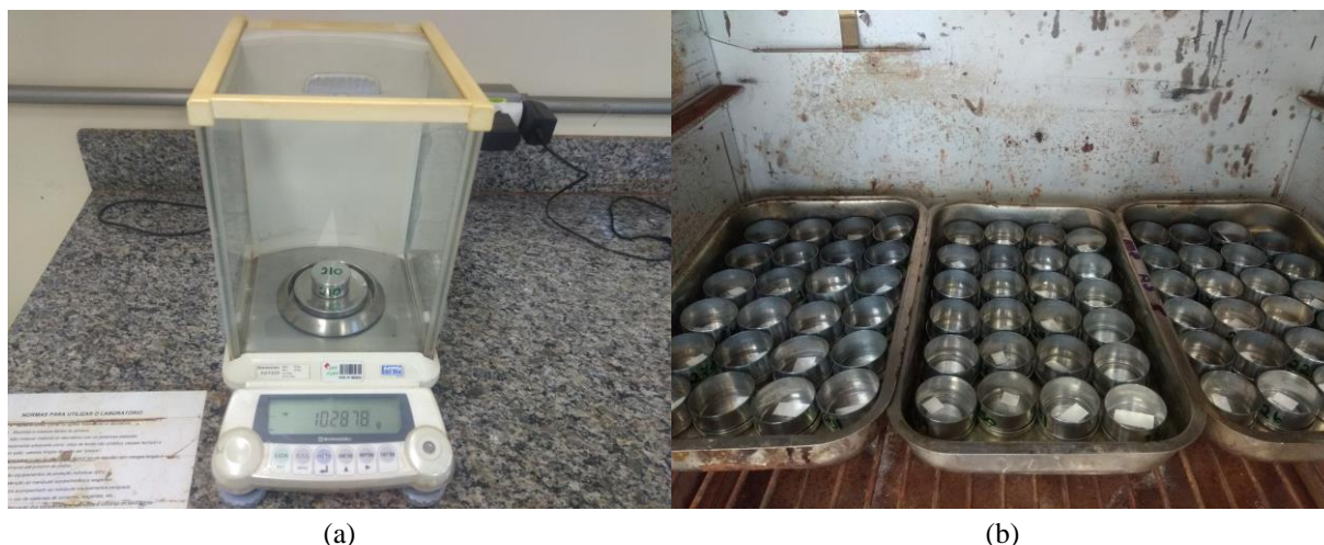
Figura 4.18: Processo de pesagem do papel filtro: (a) Balança de precisão; (b) capsulas contendo o papel filtro na estufa para secagem.
