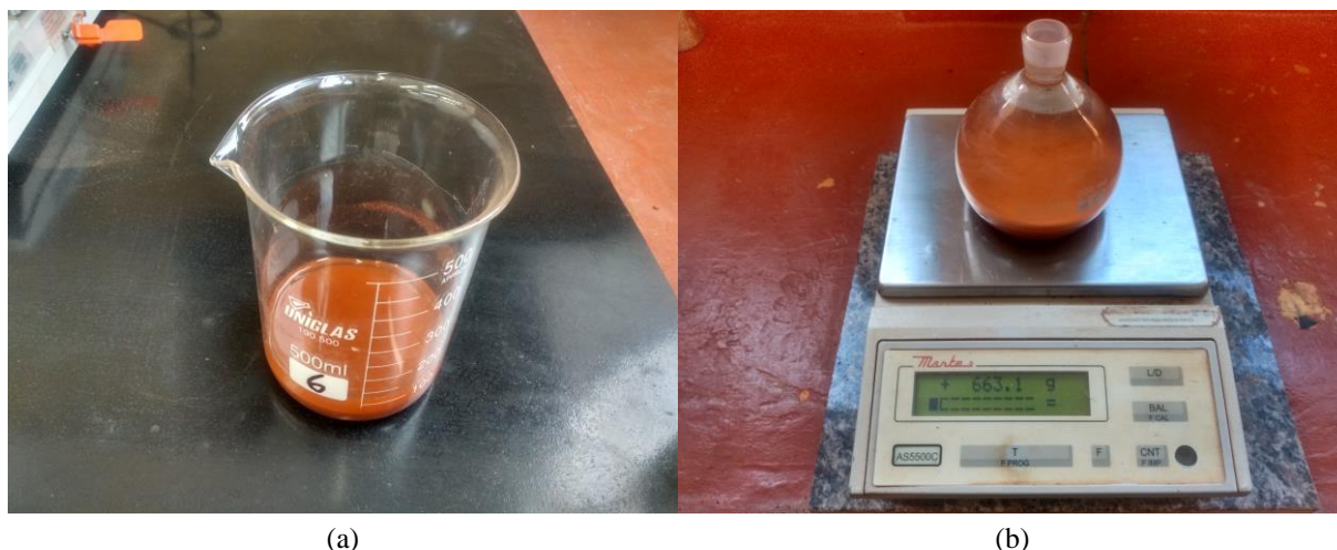
Figura 4.14: Determinação do peso específico dos grãos: (a) amostra em repouso; (b) etapa de pesagem.
