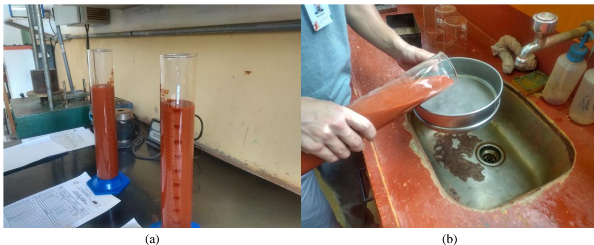
Figura 4.15: Análise granulométrica: (a) etapa de sedimentação; (b) etapa de lavagem do solo para posterior peneiramento fino.
