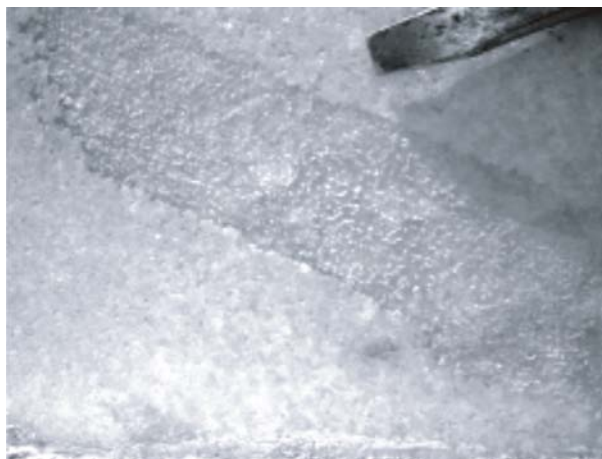
Figura 6 – Intensa dissolução de banda rica em calcita.
