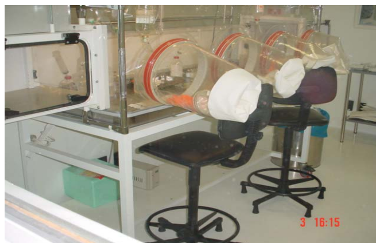
Figura 4. Isolador/capela de manipulação de NPT e OMI.
