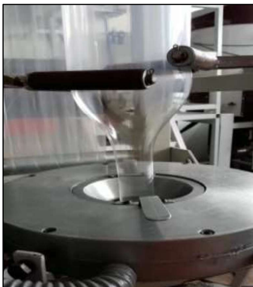
Figura 22 – Balão mantido com diâmetro constante no processo de extrusão dos filmes analisados.
