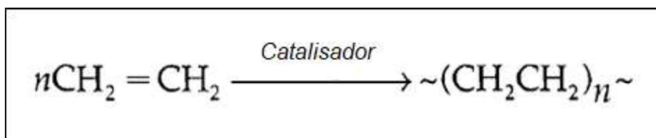
Figura 12 – Esquema de polimerização do eteno com produção do polietileno.
