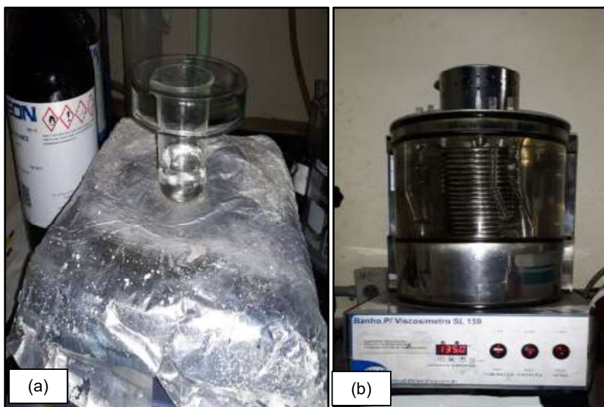
Figura 27 – (a) Preparo das soluções de polietileno a 140°C, (b) viscosímetros imersos em banho de óleo de silicone a 135°C para a realização das análises.
