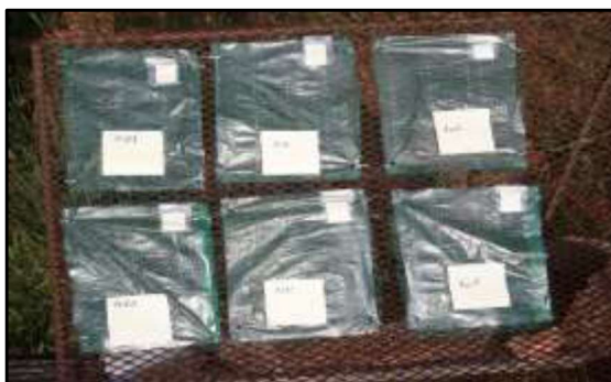
Figura 24 – Amostras dos filmes PEAD/PEBD expostos ao intemperismo natural em Porto Alegre.
