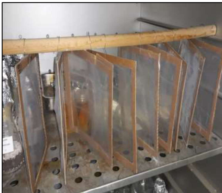
Figura 26 – Amostras dos filmes de PEAD/PEBD dispostos em estufa a 58°C.
