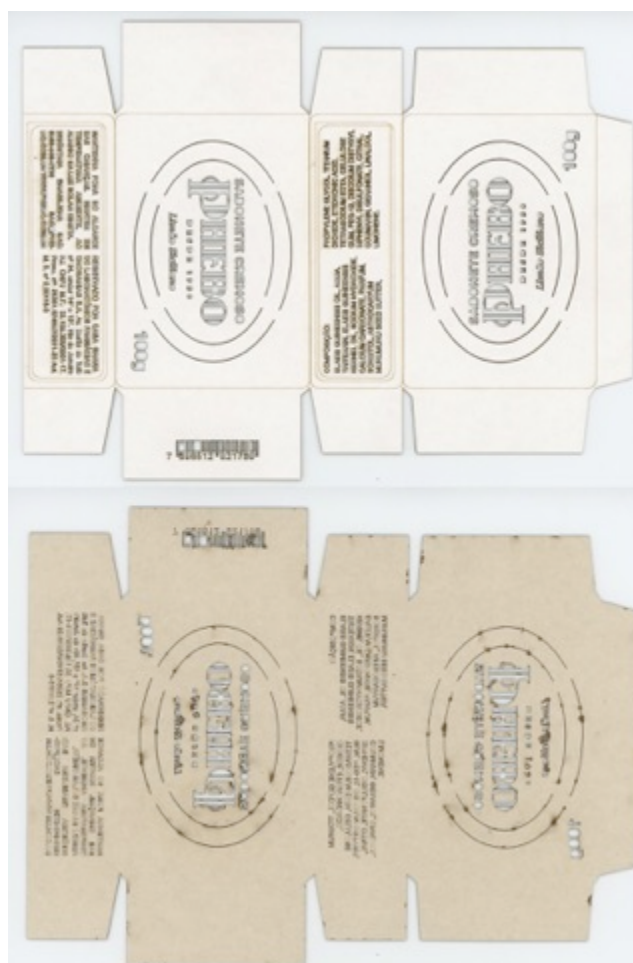
Figura 60: Embalagem executada em corte a laser - tamanho original.
