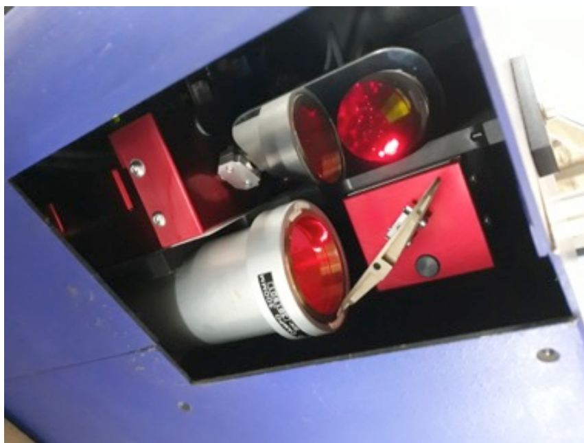
Figura 57: Sistema de lentes do corte a laser.
