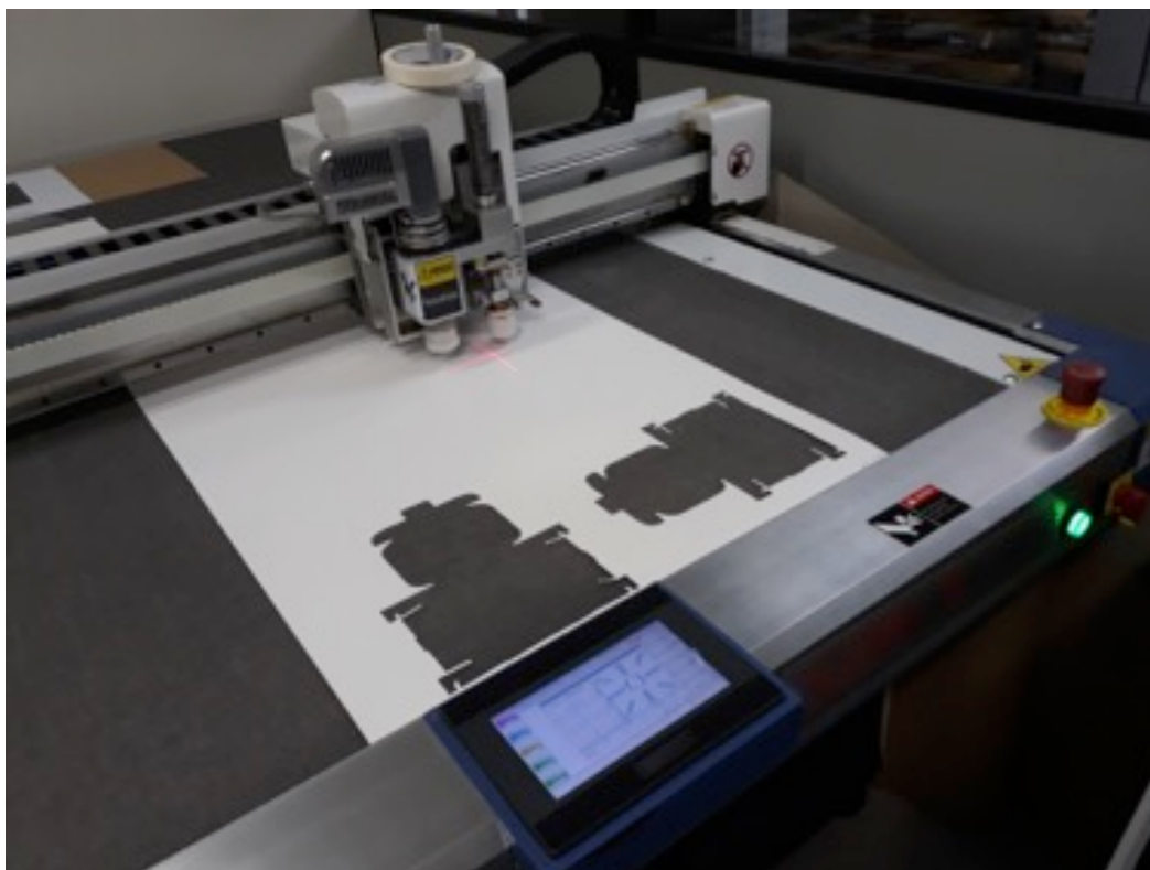
Figura 55: Modelo de equipamento de plotter de recorte.
