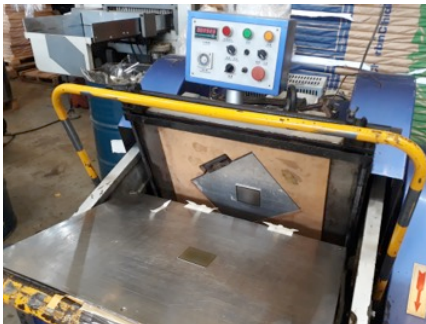
Figura 51: Equipamento para faca de corte e vinco, e relevo seco, manual e plano.
