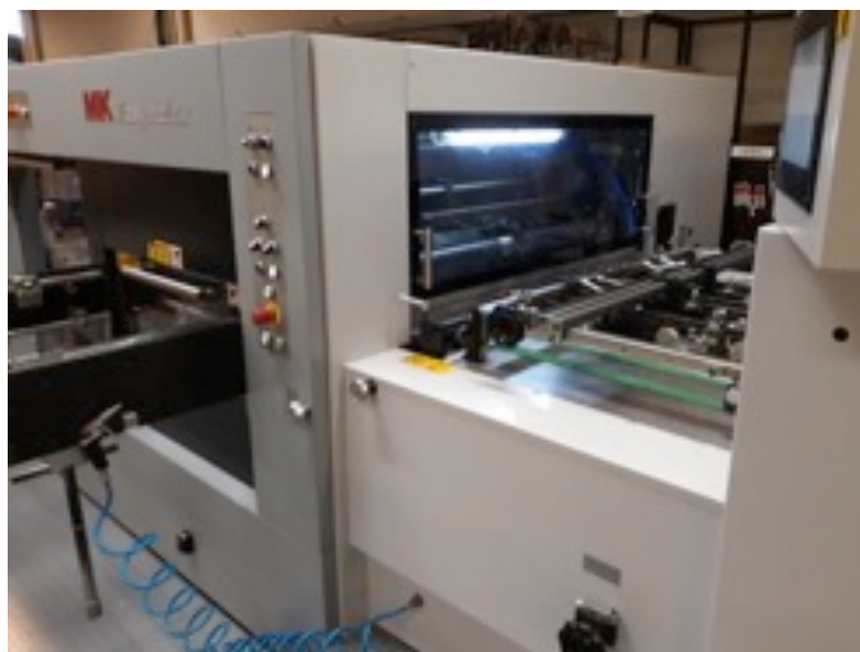
Figura 52: Equipamento para faca de corte e vinco, e relevo seco, automático e plano.
