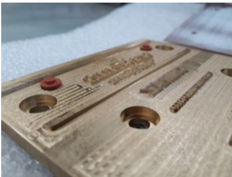
Figura 53: Modelo de clichê para relevo seco.
