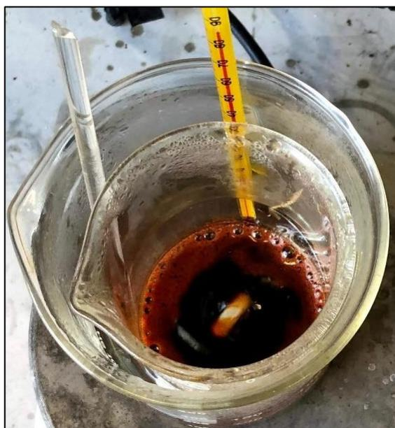
Figura 11. Síntese de ferrita de cobalto pela método sol-gel. Na foto, os precursores em banho maria a 85°C sob agitação magnética.
