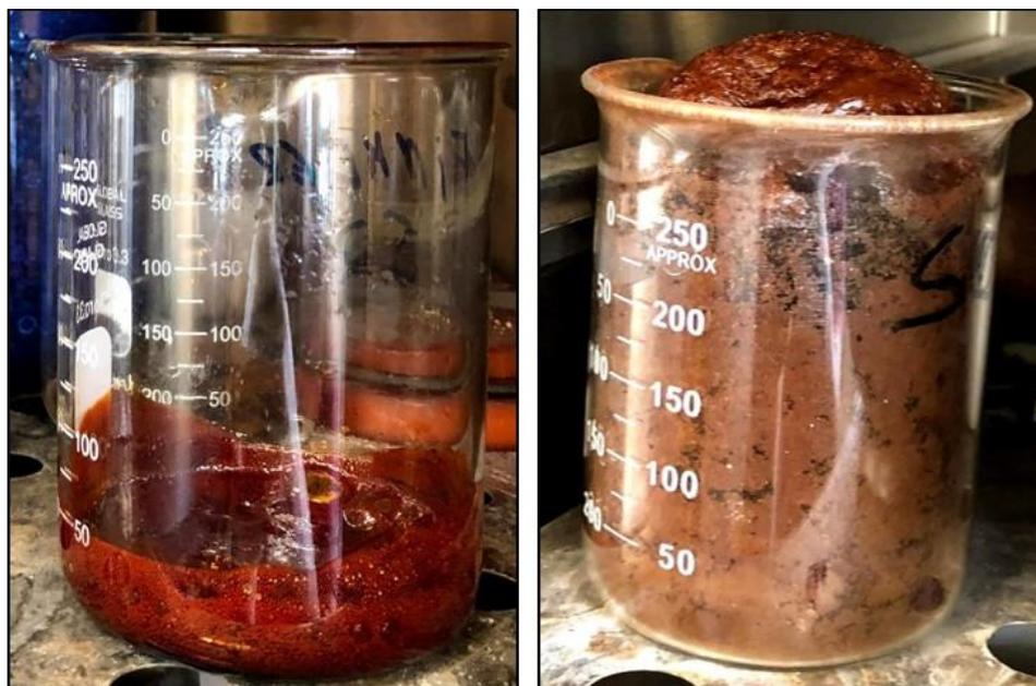
Figura 12. Síntese de ferrita de cobalto pelo método sol-gel. Nas fotos, como ficam os aspectos do produto antes da secagem (à esquerda) e após a secagem (à direita), a 110°C por 24 horas.
