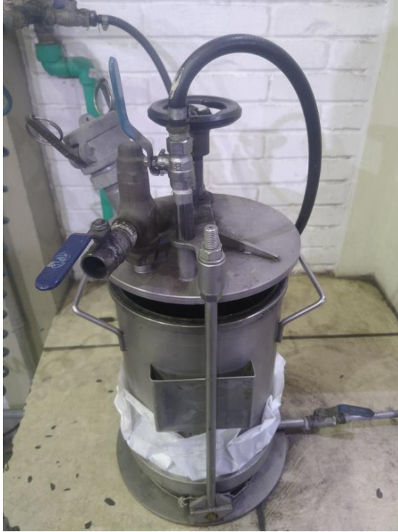
Figura 23 - Filtro de pressão
