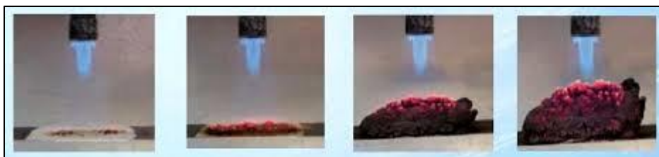
Figura 12. Formação da camada carbonosa em uma tinta intumescente durante o contato direto com uma chama. Adaptado de http://www.pinturaintumescente.com.br/ .
