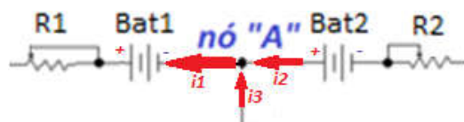
Figura 34 - Alterando i_1 , i_2 e i_3 através de R1, R2, Bat1 e Bat2
