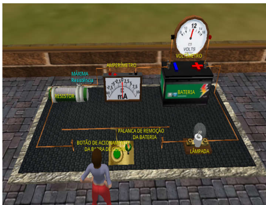
Figura 36 - Circuito auxiliar de Kirchhoff
