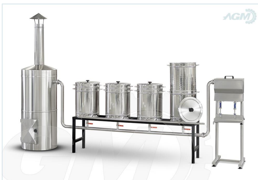
Figura 3.5 – Conjunto de panelas extradoras por arraste de vapor. À esquerda está a fonte de aquecimento, quatro panelas ao centro e uma envasadora manual à direita (GUERRA et al. , 2016). Fonte: AGM Máquinas Ltda.
