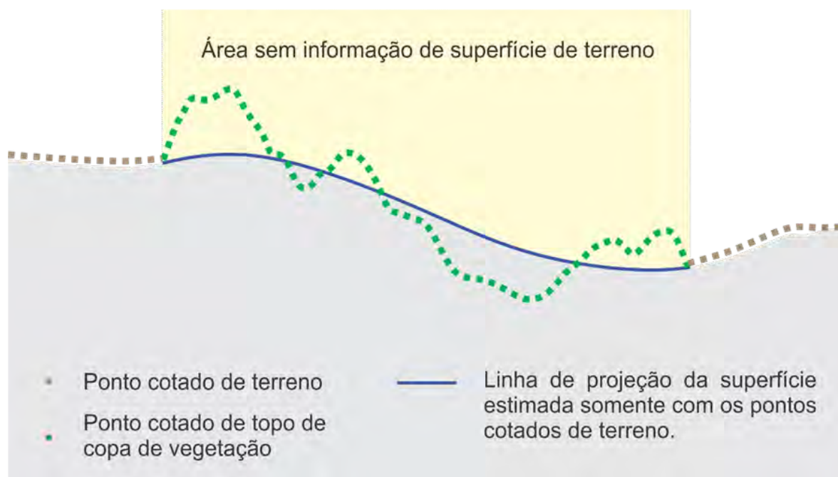
Figura 3 – Perfil esquemático contendo os pontos cotados do terreno e de copa de vegetação e a linha da projeção da superfície de um modelo estimado somente com os dados de cota do terreno
