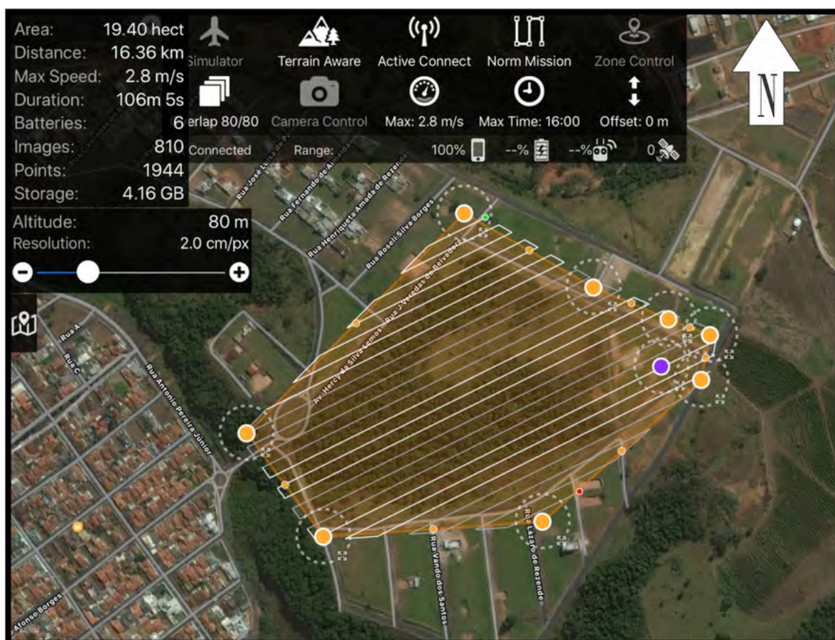
Figura 22 – Imagem de captura da tela do planejamento de voo no aplicativo utilizado para planejamento e execução das missões (Map Pilot).
