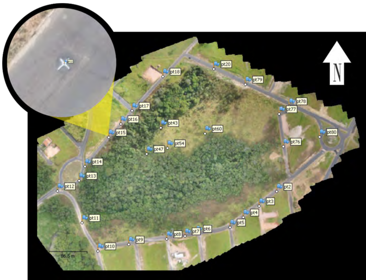
Figura 25 – Localização dos pontos de controle, em destaque ponto de controle marcado no asfalto.
