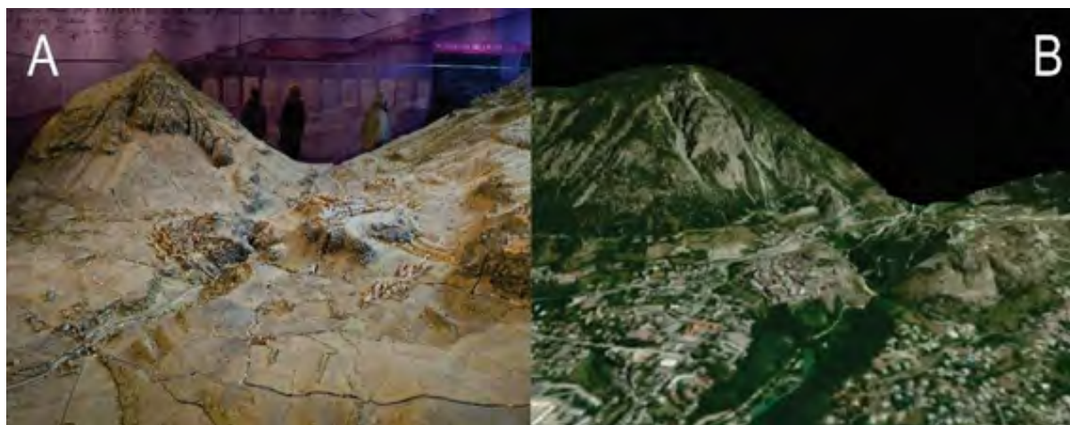
Figura 6 – Modelos de superfície de Briançon - França. (A) Modelo em madeira, papel e metal, escala 1:600 (Nézot, 1736). (B) Modelo computacional com grid CoNED, 2013 de resolução de 3 metros.
