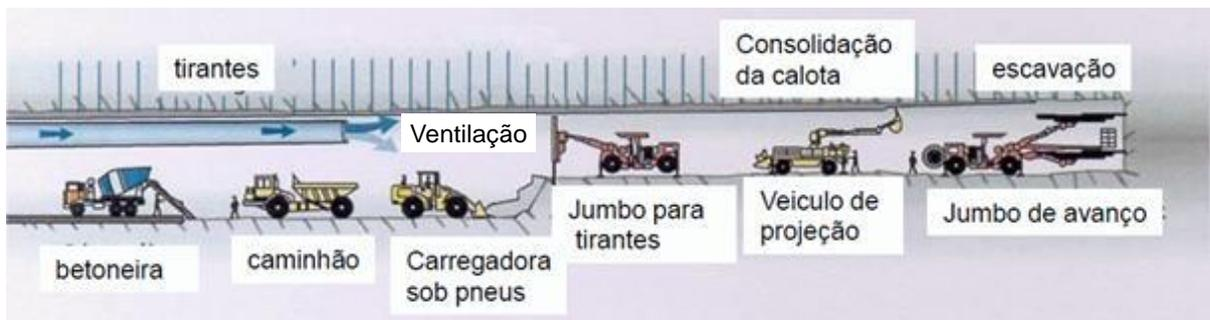
Figura 11 Sequência executiva do método de construção com uso de escavadeira
