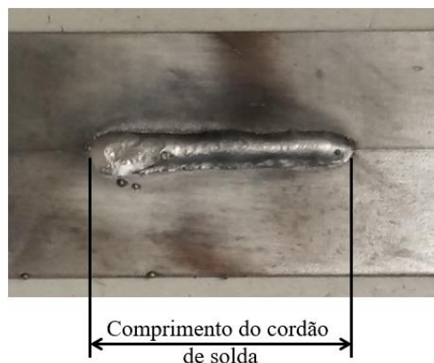
Figura 21 - Extensão verificada no cordão de solda.
