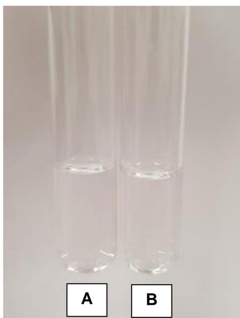
**Figura 10.** Aspecto visual das soluções obtidas após A) MW-AD com ácido concentrado e B) MW-AD com ácido diluído.
