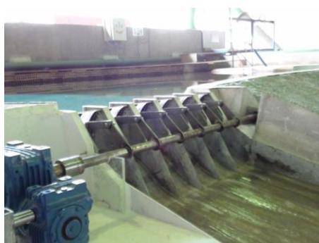
Figura 3.6: sistema de funcionamento das comportas com redutor de frequência de rotação (ELETROBRAS FURNAS, 2010)
