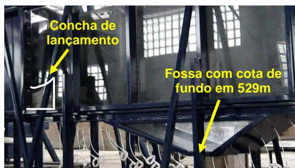
Figura 3.21: modelo do LOH em escala 1:100; detalhe da concha de lançamento do vertedouro e a representação da fossa com cota de fundo em 529,75m
