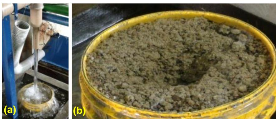
Figura 3.12: (a) teste em andamento; (b) corpo de prova erodido.
