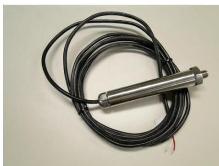
Figura 3.20: foto do transdutor de pressão utilizado no modelo do LAHE (ELETROBRAS FURNAS, 2010)
