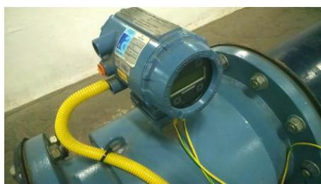
Figura 3.27: medidor eletromagnético de vazão utilizado para conferir a vazão escoada pelo modelo bidimensional de escala 1:100
