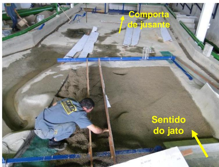
Figura 3.8: vista para jusante do modelo de conjunto em escala 1:100 – processo de aplicação do leito coesivo submetido à erosão (ELETROBRAS FURNAS, 2010)
