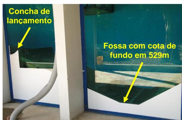
Figura 3.13: modelo do LAHE em escala 1:50; detalhe da concha de lançamento do vertedouro e a representação da fossa com cota de fundo em 528,95m (ELETROBRAS FURNAS, 2010)
