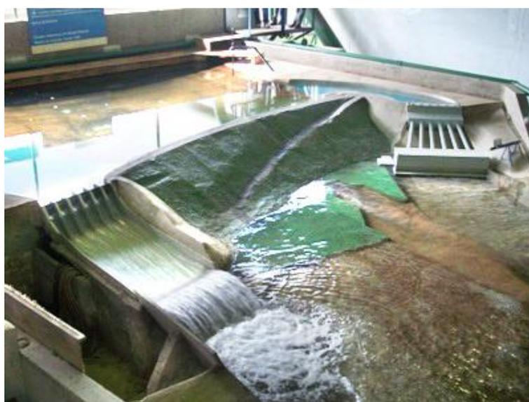
Figura 3.5: modelo de conjunto em escala 1:100
