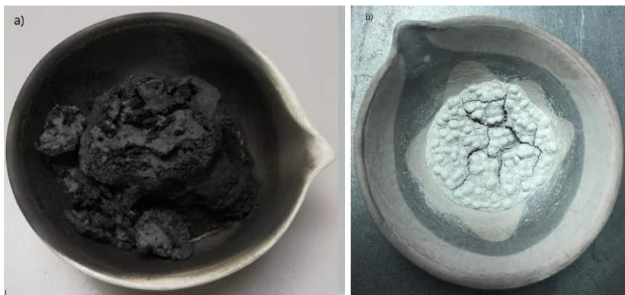
Figura 21 – Registro fotográfico do cadinho com teor de residual após ensaios de calcinação das amostras a) não halogenadas e b) halogenadas.
