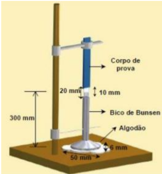
Figura 15 – Desenho esquemático do teste de chama vertical UL 94 (INNES, J; 2003) e critérios para classificação conforme norma UL94.
