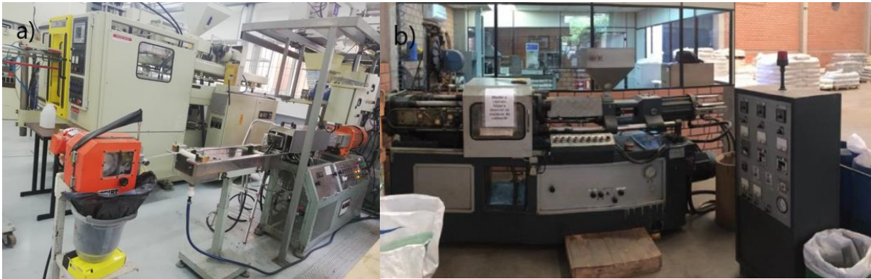
Figura 13 – Registro fotográfico da extrusora duplarrosca do LPOL/UCS (a) e injetora da empresa Leopolymer (b).
