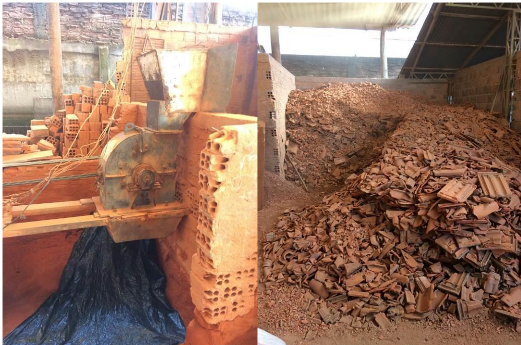
Figura 14 – Trituradora (a), resíduo cerâmico (b)
