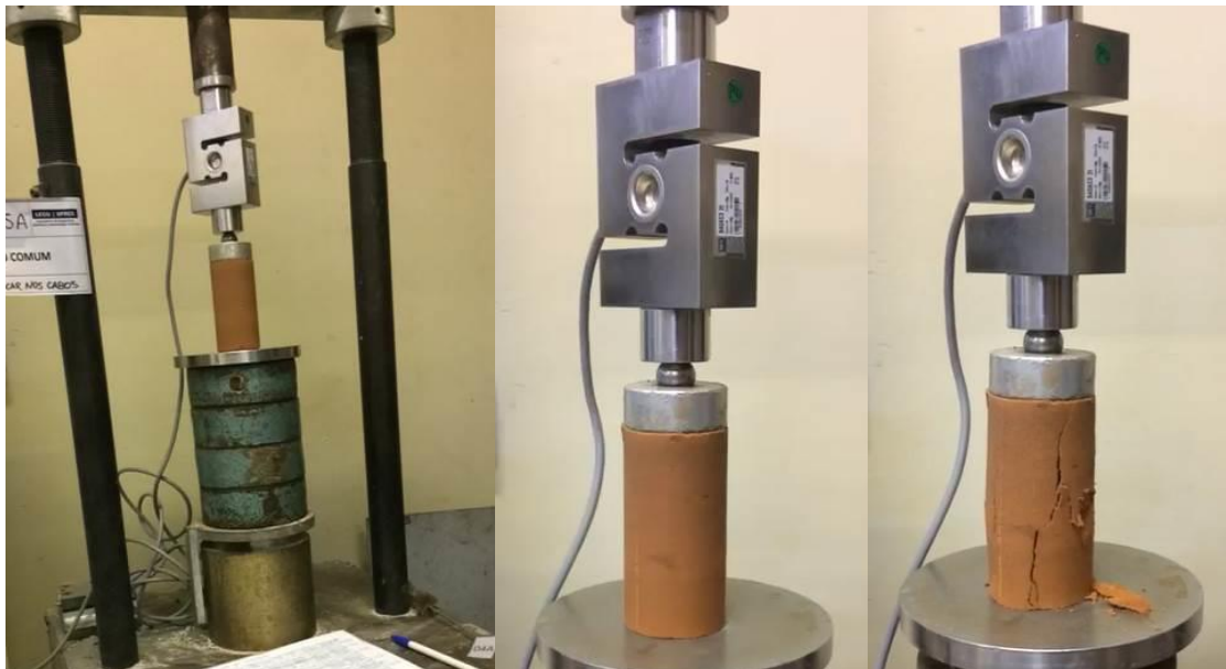
Figura 21 – Ensaio RCS: (a) prensa, (b) antes da ruptura e (c) após a ruptura
