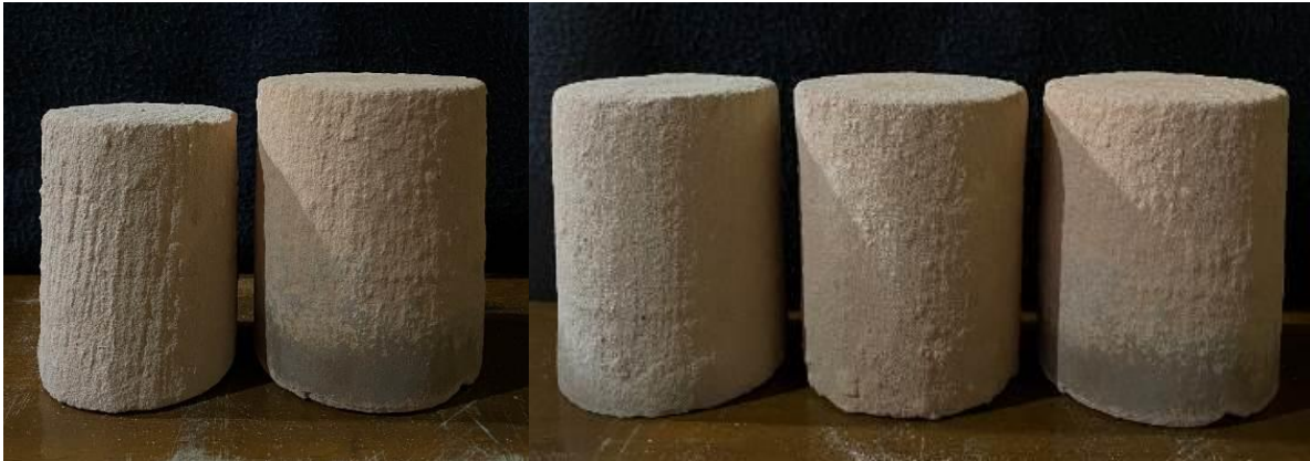
Figura 24 – Ensaio de durabilidade após 12 ciclos de molhagem/secagem e escovação: (a) CPs com maior e menor PMA e (b) CPs com \gamma_d=17\text{kN/m}
