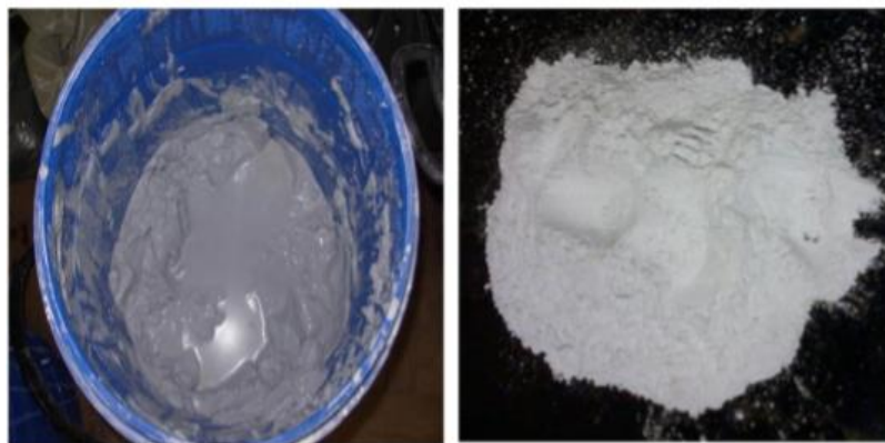
Figura 18 – (a) armazenamento e (b) CC após secagem e peneiramento (SALDANHA, 2014)
