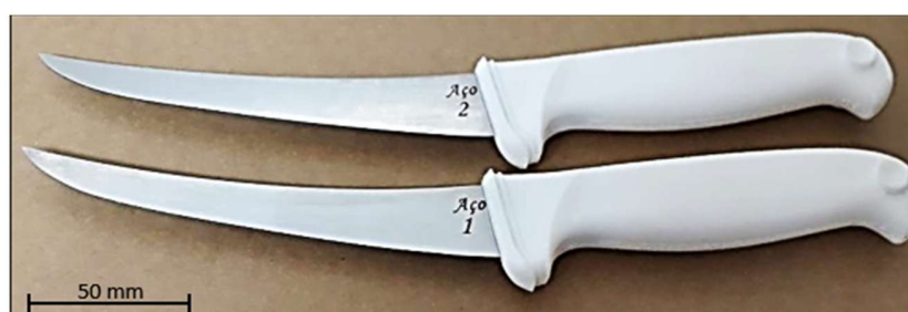
Figura 31: CPS utilizados para o teste de Desgaste de Fio de Corte
