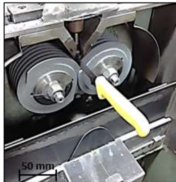
Figura 32: Rebolos helicoidais utilizados para afiação das facas
