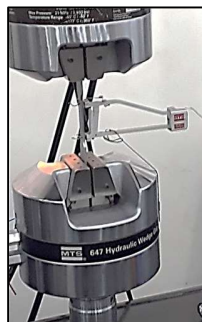
Figura 30: Extensômetro usado para medir o alongamento
