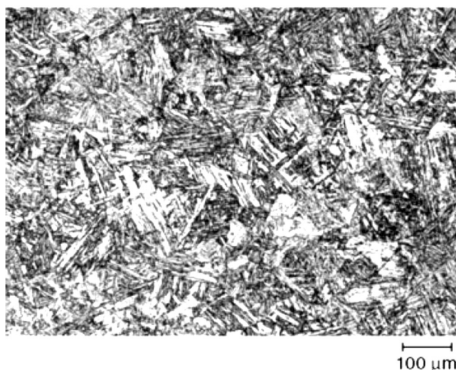
Figura 16 – Matriz de Aço Inoxidável Martensítico (41 HRC) Fonte: ASM Metals Handbook, vol 9, 2004, p.1651.
