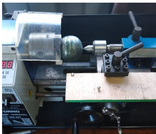
Figura 3.3 – Processo de diminuição de sobressaltos e rugosidades da esfera.
