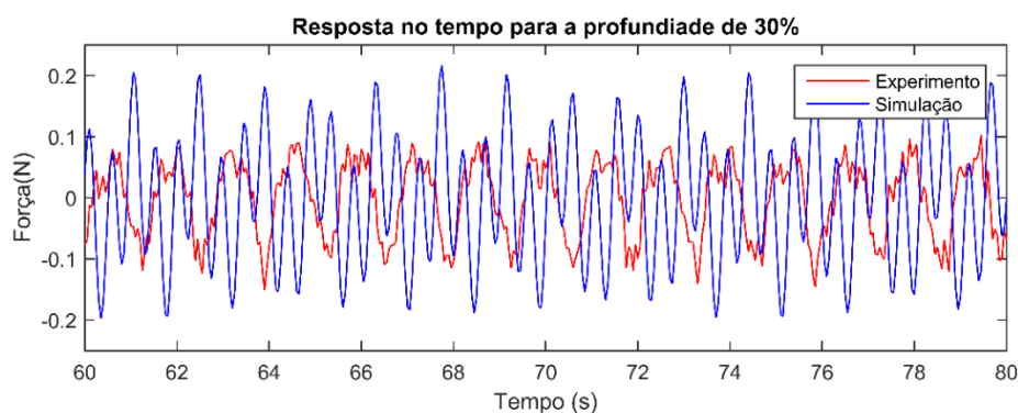
Figura 5.4 – Ampliação da resposta do cabo de rigidez 187.17, excitado por onda de 0,75 Hz em uma profundidade de 30%.
