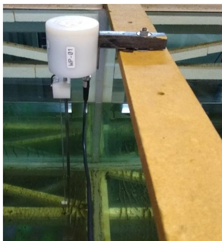
Figura 3.2 – Wave probe (WP) instalado no canal para medição de elevação da superfície da onda.
