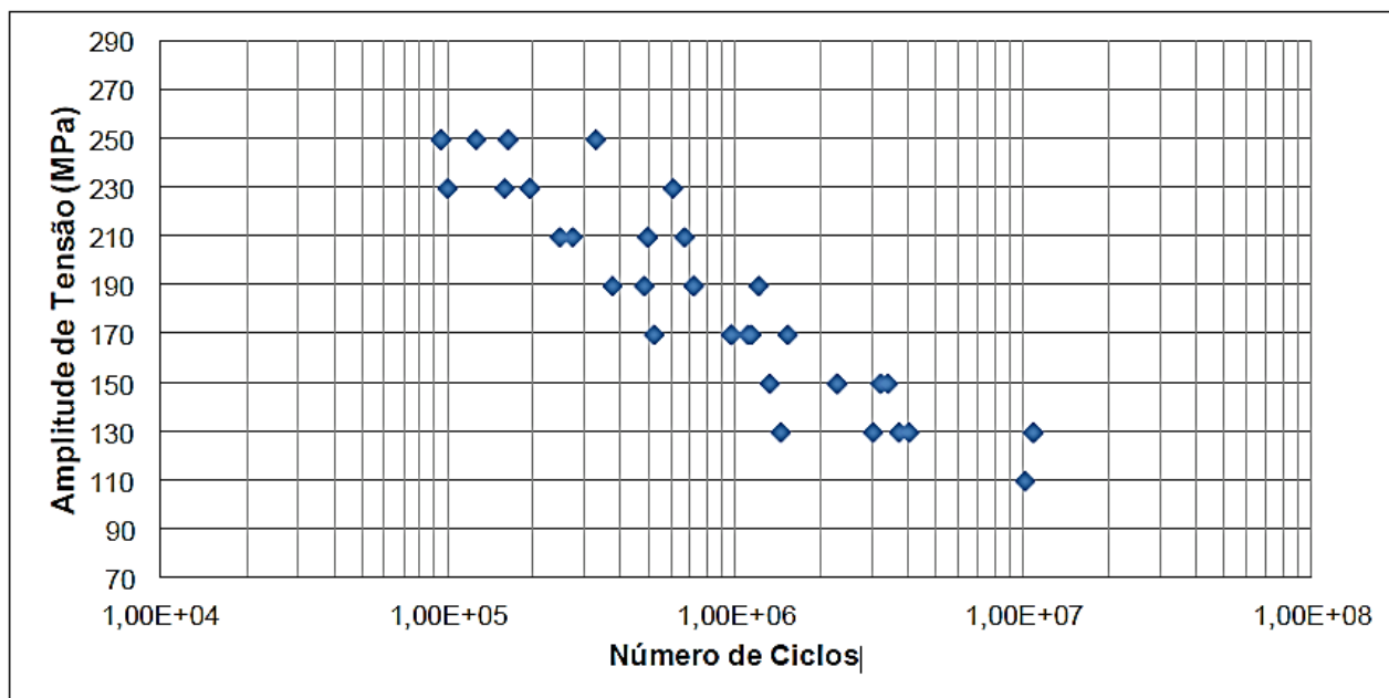
Figura 3-13 - Gráfico de fadiga, obtida por flexão alternada a partir das juntas soldadas recebidas para análise.
