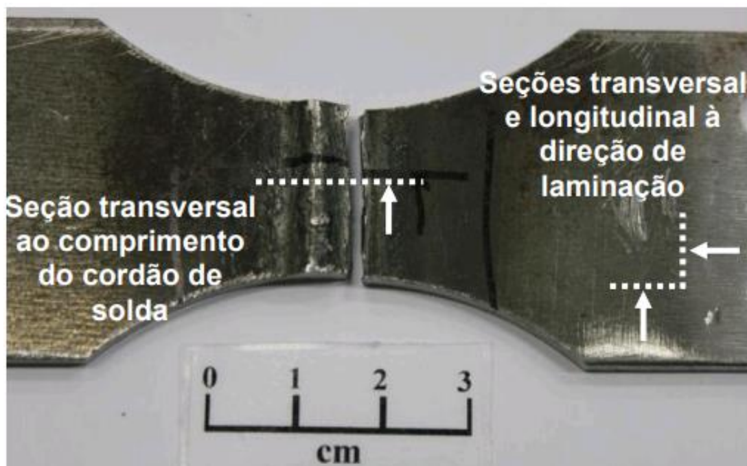
Figura 3-7 - Ilustração da posição de retirada (linhas tracejadas) e do ângulo de visão (setas) das seções observadas ao longo da espessura da amostra.
