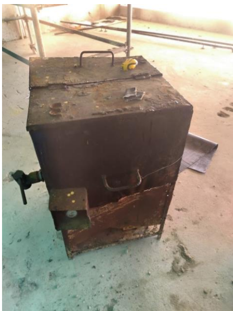
Figura 15 - Equipamento que faz o aquecimento do asfalto
