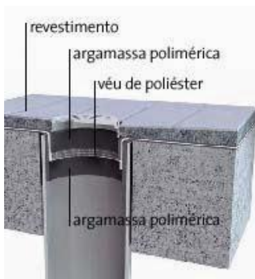
Figura 4 - Detalhamento de impermeabilização em ralos
