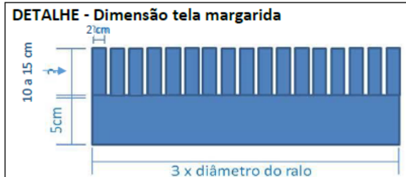
Figura 40 - Dimensões indicadas para corte da tela estruturante para ralo
