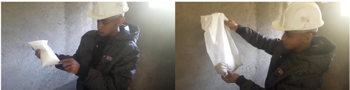
Figura 73 - Componentes (líquida e em pó) da argamassa impermeabilizante
