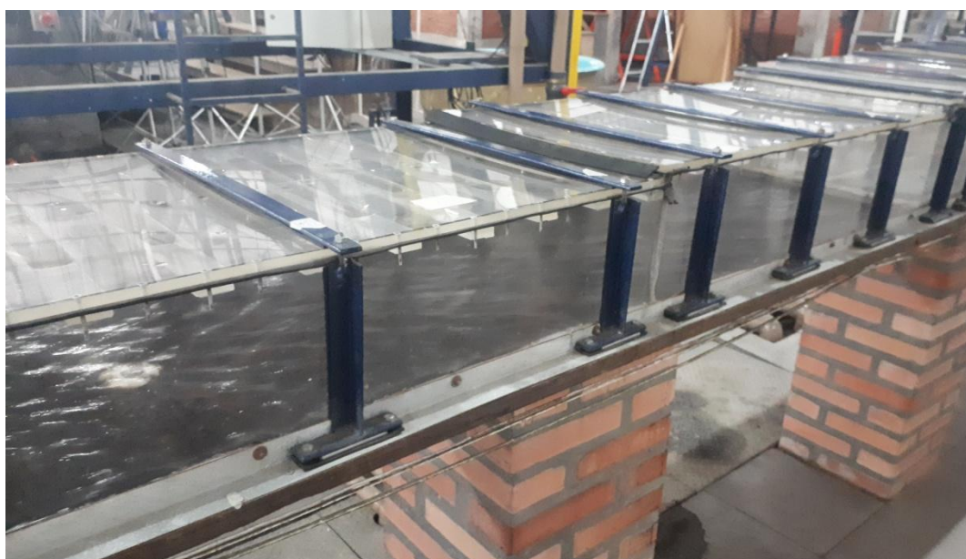
Figura 5 – Trecho do modelo reduzido do conduto Álvaro Chaves
