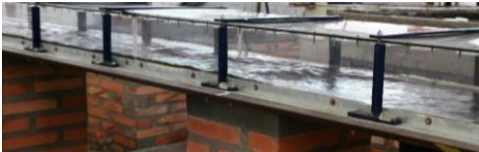
Figura 32 – Ressalto hidráulico seguido por ondulações
