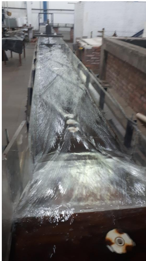
Figura 37 – Propagação das ondas da contração lateral do modelo até ressalto hidráulico
