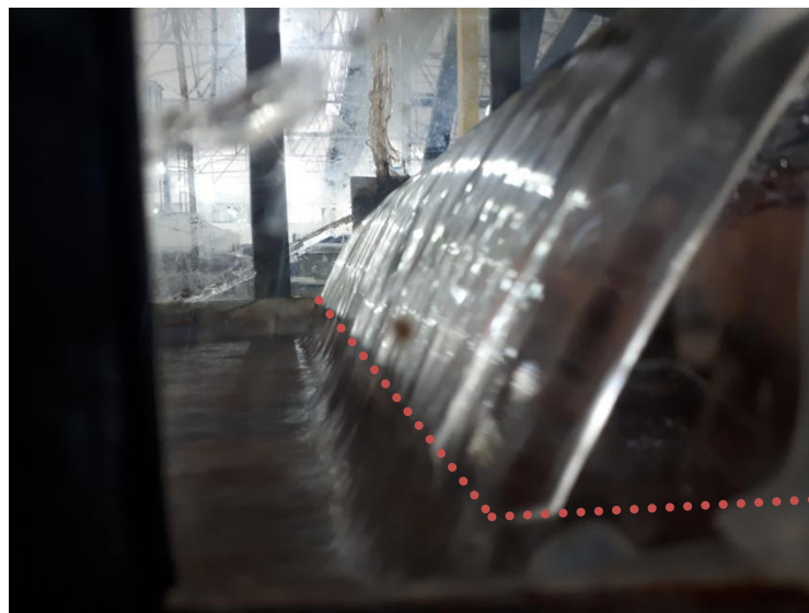
Figura 25 – Linha de água entre a lâmina e paramento do degrau
