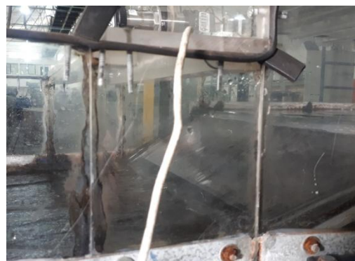
Figura 13 – Foto do trecho 2 em degrau inclinado a 50% (original)
