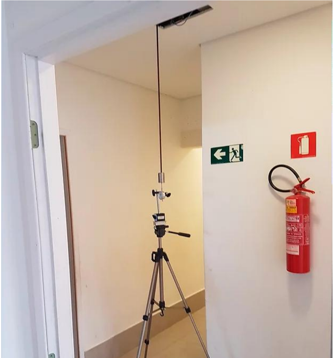
Figura 39 - Medição dos deslocamentos na laje sob prova de carga através de relógio comparador mecânico ou de LVDT
