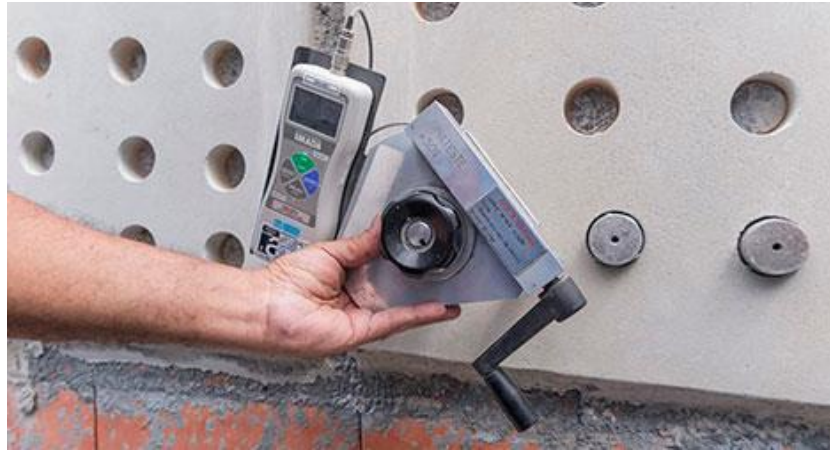
Figura 41 – Ensaio de arrancamento
