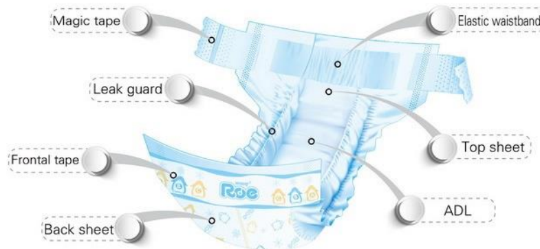
Figura 3: Desenho esquemático das partes que compõem uma fralda descartável (fonte: material interno)
