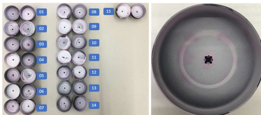
Figura 7 – Ensaio de líquidos penetrante.
