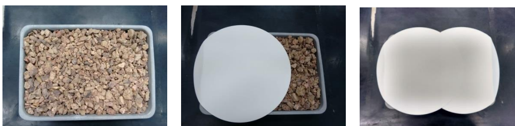
Figura 3: Etapas do procedimento de preparo das bandejas para recebimento dos lodos
