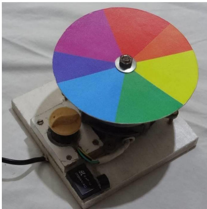
Figura 28 – OAP Disco de Cores Motorizado. Com disco de Newton acoplado.
