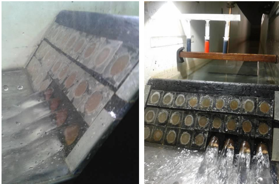
Figura 18 – Modelo Físico I – Escala 1:80. Produzido principalmente a base de espuma de poliuretano e resina.
