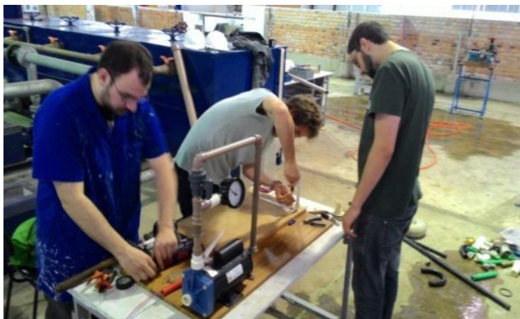
Figura 15 – Construção do modelo didático para ensino de hidráulica e eletricidade.
