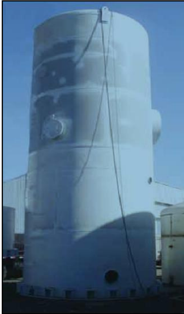
Figura 2.17 - Vasos de pressão com costado cilíndrico [JORNALCANA ® (2008)].
