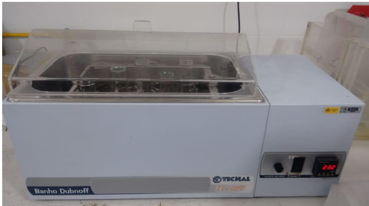
Figura 8 - Equipamento utilizado (Banho Dubnoff TE-053) para agitação das amostras do estudo
