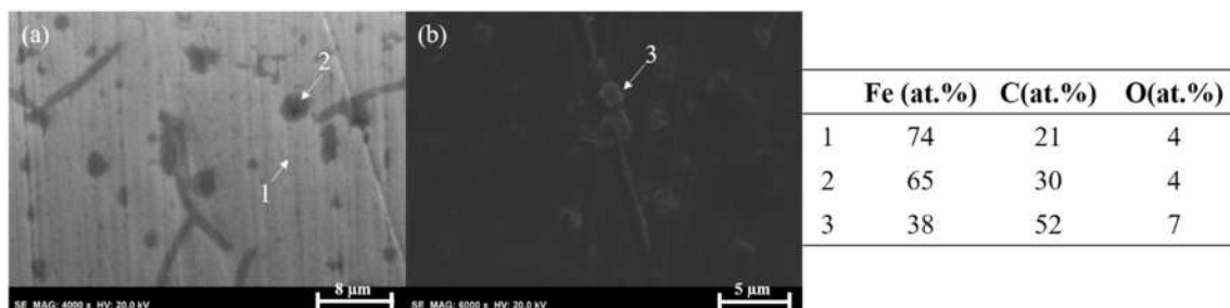
Figura 50. Imagens MEV e quantidade de carbono, oxigênio e ferro em diferentes pontos da superfície do aço após o teste SVET com [m-2HEA][OI] e cloreto de sódio.
