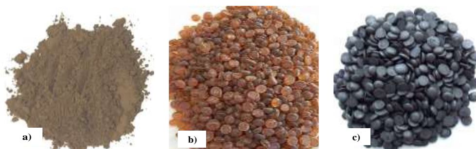
Figura 16. Imagens dos aditivos de proteção usados em estudo: a) Lignina como antioxidante; b) TMQ como antioxidante e; c) 6PPD como antiozonante/antioxidante.
