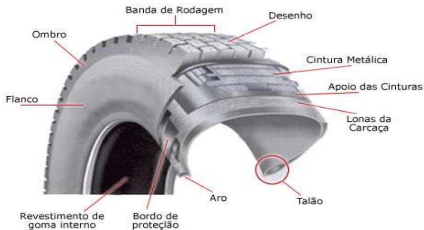
Figura 1. Partes de um pneu radial.
