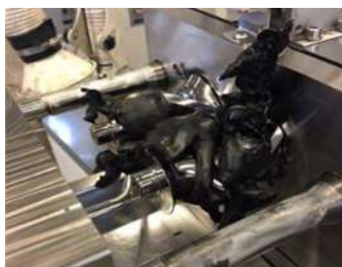
Figura 28. Descarregamento de uma composição de borracha após primeira fase de mistura em Haake.
