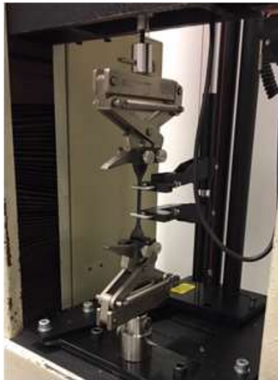
Figura 19. Imagem do ensaio de tração de uma das amostras na máquina Universal de Ensaios EMIC.
