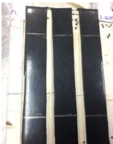
Figura 21. Corpos de prova alongados em 20% sobre suporte de madeira com região de análise demarcada na cor prata.
