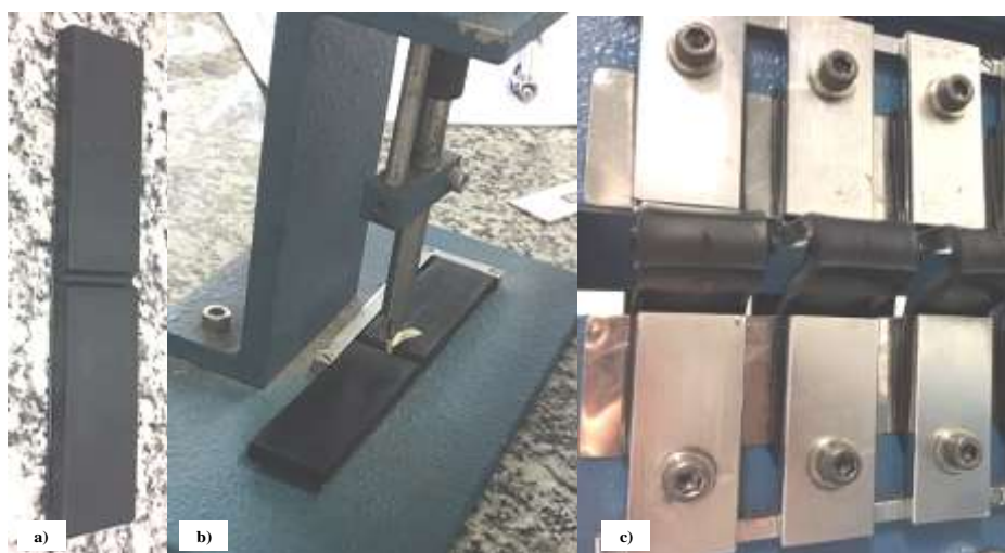
Figura 20. Etapas de preparação para o ensaio de Flexão de Mattia: a) corpo de prova vulcanizado; b) entalhe padronizado na região de menor espessura do corpo de prova e; c) corpos de prova em ensaio no Flexômetro.
