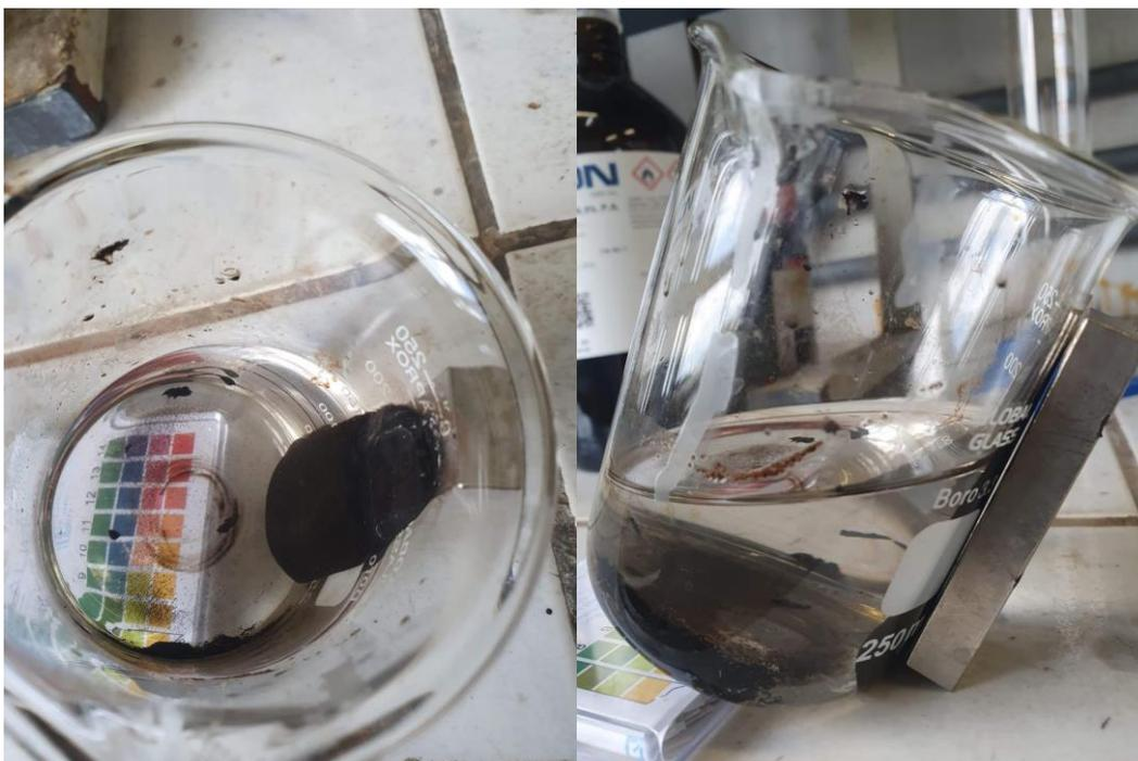
**Figura 4.2** Separação magnética das nanopartículas sintetizadas no presente trabalho.
