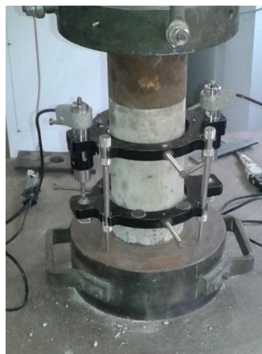
Figura 28: Corpo de prova durante o ensaio de módulo de elasticidade
