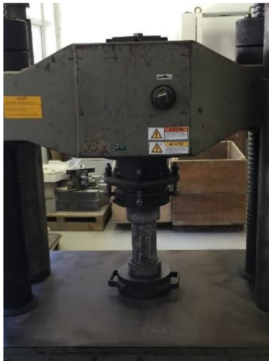
Figura 26: Prensa utilizada para o ensaio de resistência à compressão axial
