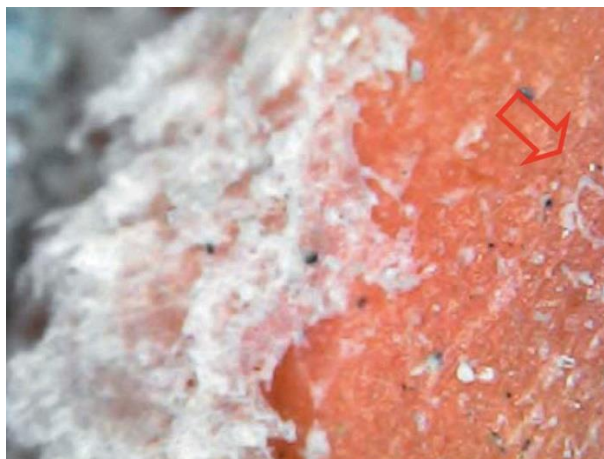
Figura 36: Precipitação de cristais de hidratação na superfície do PP tratado
