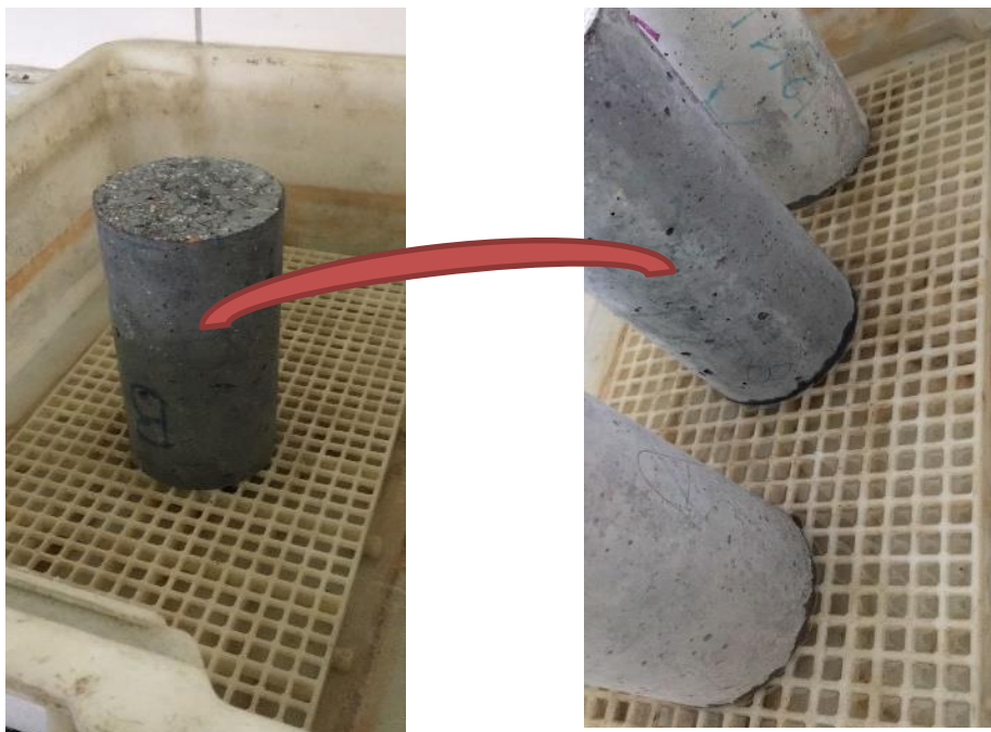
Figura 29: Determinação da absorção de água por capilaridade
