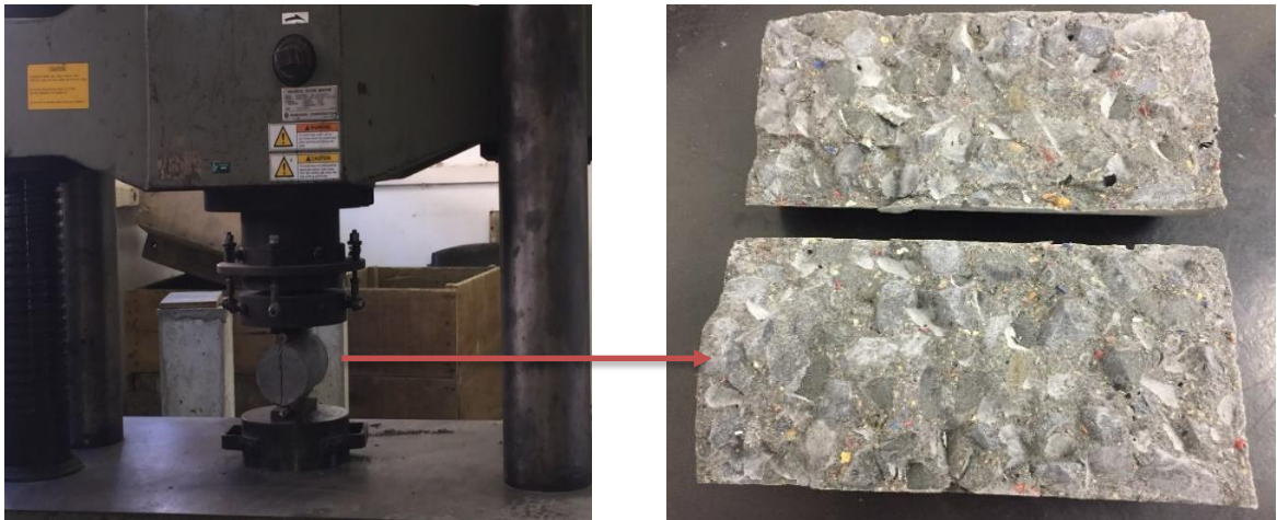
Figura 27: Registros do ensaio de resistência à compressão diametral
