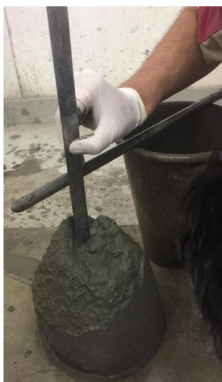
Figura 25: Determinação da consistência pelo abatimento do tronco de cone.
