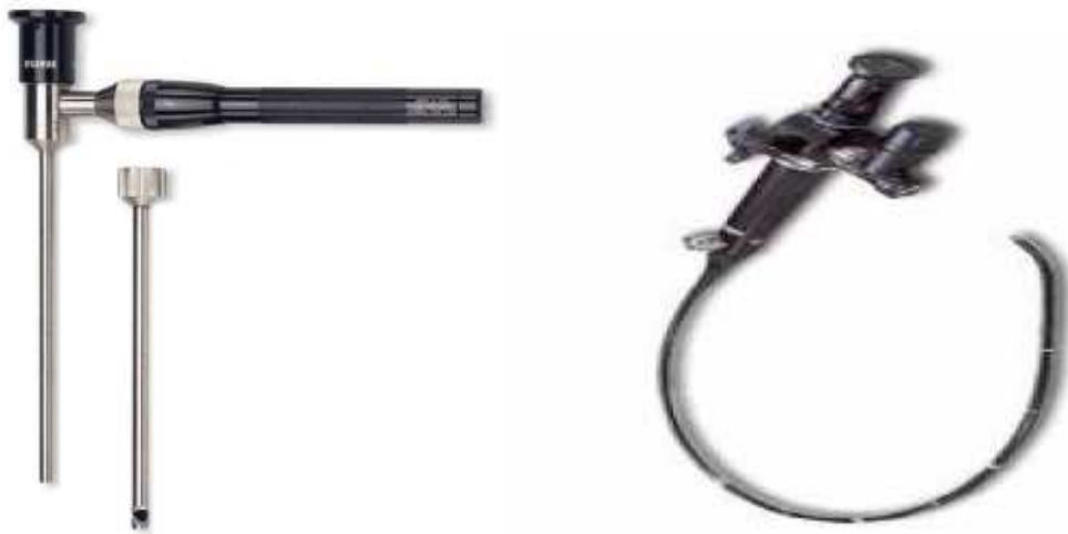
Figura 2-2 – Boroscópio e Fibroscópio. 5
