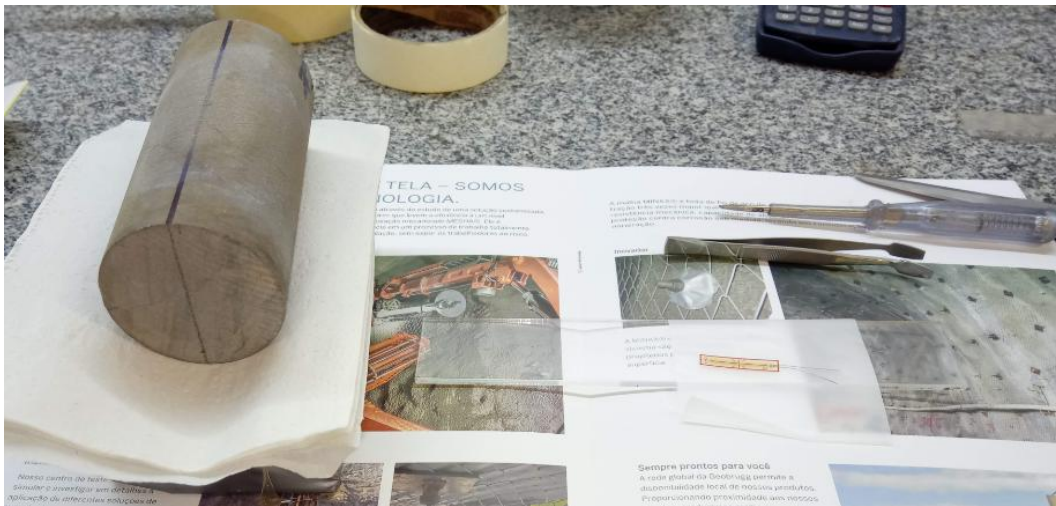
Figura 55 Aplicação do Strain Gauge à superfície do corpo de prova. Detalhe do auxílio da pinça e espátula para garantir a manutenção de superfície do strain livre de impureza.
