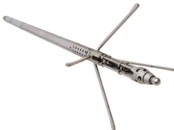
Figura 8 Sonda de perfilagem munida de dois pares perpendiculares de braços para medida do "caliper" do furo
