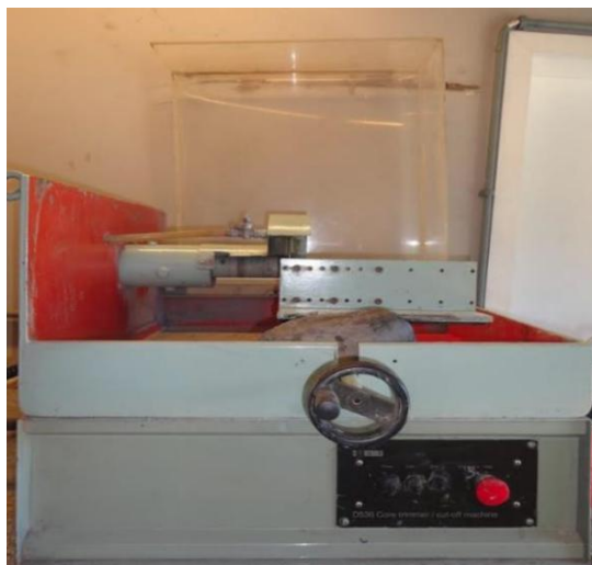
Figura 44 As manobras de 1 metro são cortadas, para atender a norma de ensaio uniaxial, na serra Core Trimmer DS-36 fabricada pela Control e disponível no Laboratório de Mecânica de Rochas da UFRGS.
