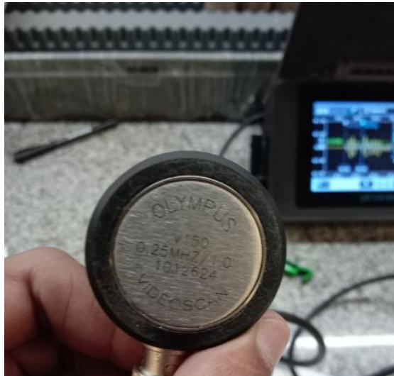
Figura 34 Transdutor de ondas cisalhantes Olympus v150. Conforme fabricante, transdutores de onda cisalhantes não devem operar em tensões de mais de 100 Volts sob o risco de as ondas cisalhantes ganharem caráter compressional com o incremento de intensidade do sinal.
