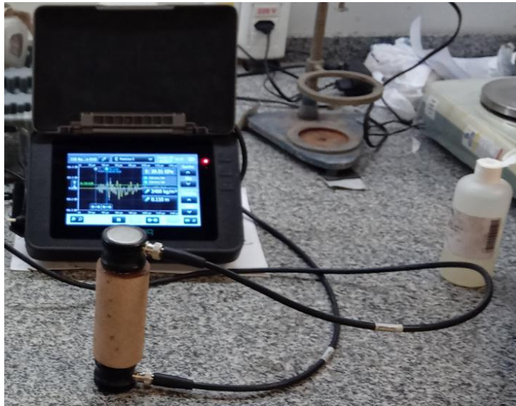
Figura 46 Imagem mostrando como se dispõe corpo de prova e transdutores. A coincidência de posição dos cabos é importante para que o transdutor receptor capte a amplitude de onda cisalhante em "vista geral".
