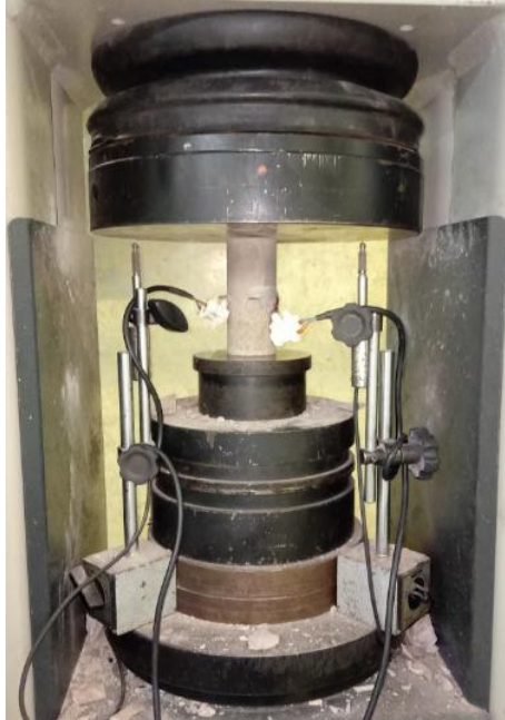
Figura 50 Ensaio de compressão Uniaxial mostrando os sensores LVDT e os fios ligando os sensores Strain Gauges para leitura da deformação radial da amostra.
