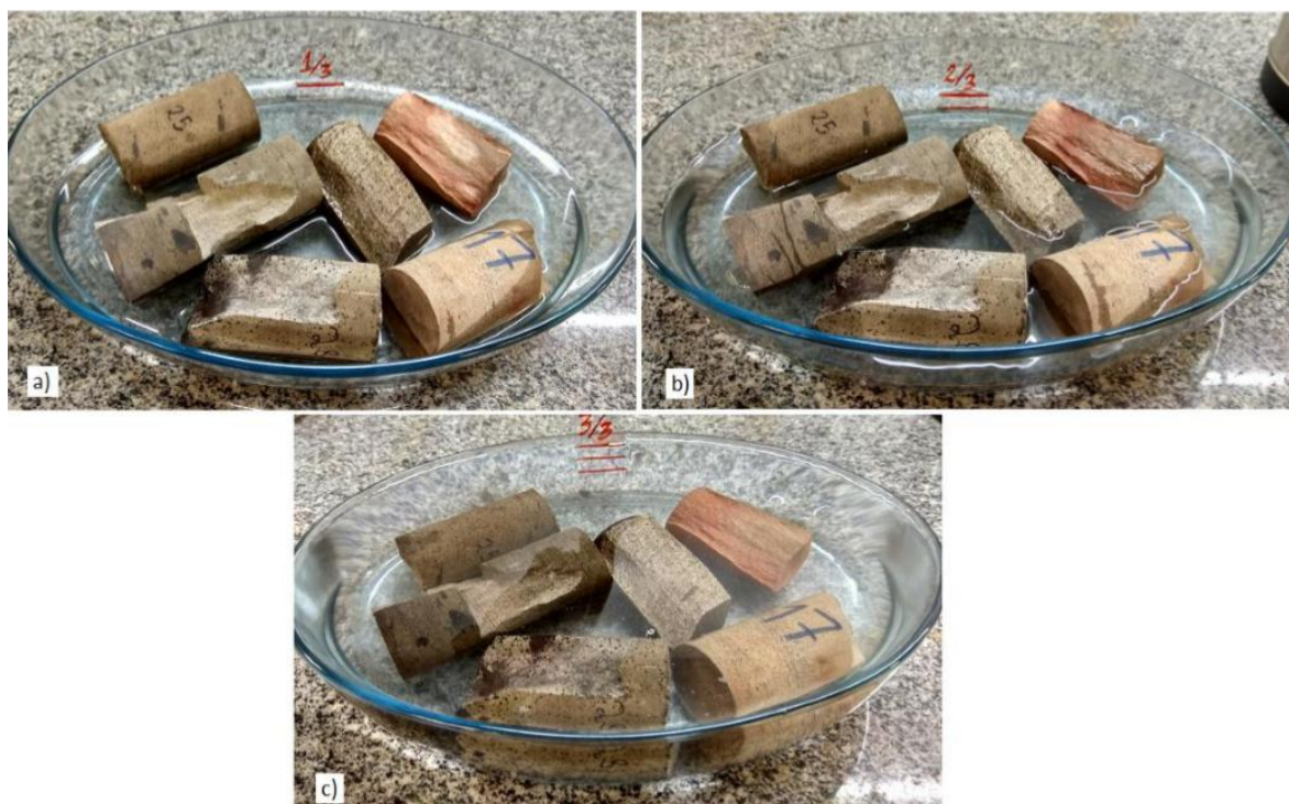
Figura 59 Amostras submetidas a imersão sob 1/3 da altura em água (a), 2/3 (b) e totalmente submersas (c)
