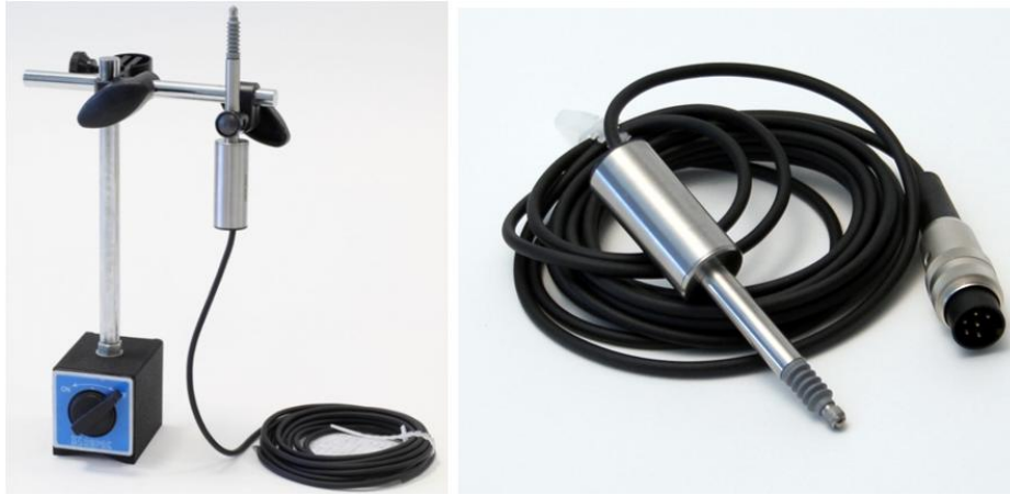
Figura 31 Sensores LVDT. À esquerda, sua configuração já montada.
