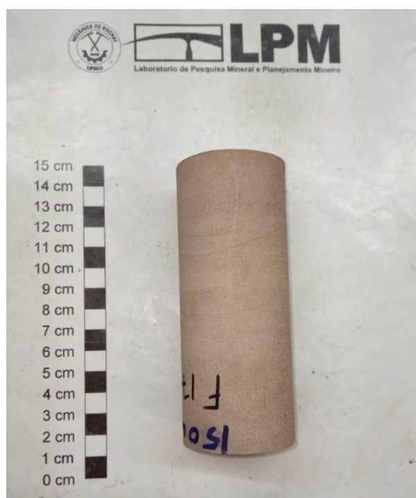
Figura 49 Exemplo de peça de testemunho utilizada nos ensaios.
