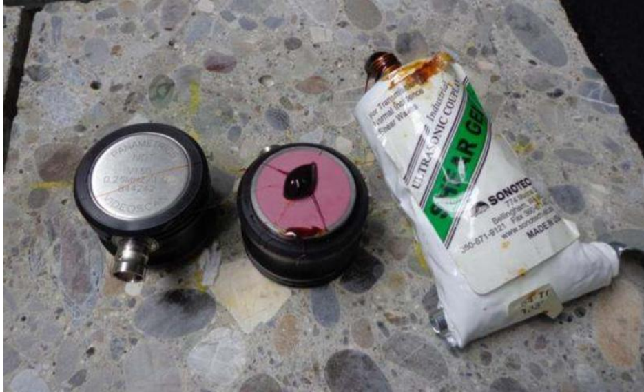
Figura 23 Transdutores de onda cisalhante de 250kHz com gel acoplante
