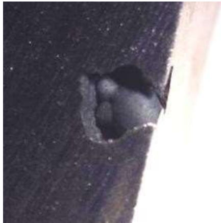
Figura 5.9 Defeito 5B. Inclusão metálica de formato esférico. Aumento 10 X.
