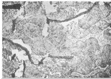
Figura 3.2. Microestrutura típica de um ferro fundido cinzento.
