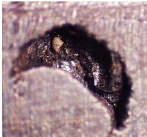
Figura 5.10 Defeito 5B. Superfície oxidada (pontos vermelhos). Aumento 10 X.
