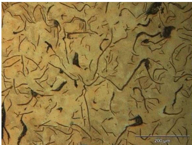
Figura 5.4 Microestrutura peça 7000. Ataque Nital 2%. Aumento 200 X.
