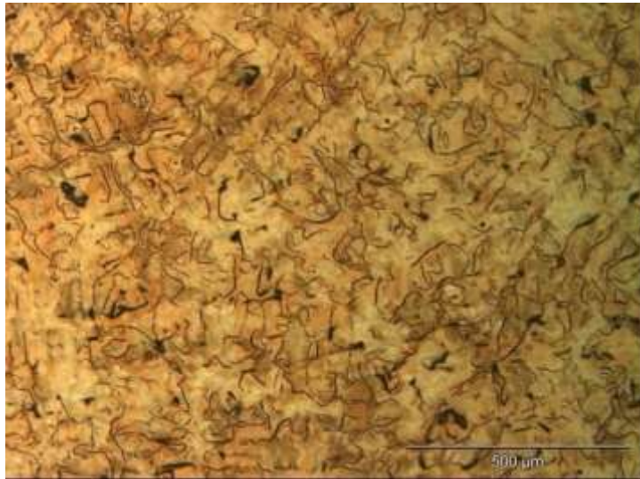
Figura 5.1 Microestrutura peça 5000. Ataque Nital 2%. Aumento 100 X.
