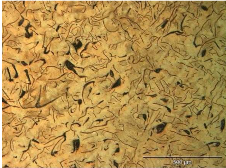
Figura 5.3 Microestrutura peça 7000. Ataque Nital 2%. Aumento 100 X.
