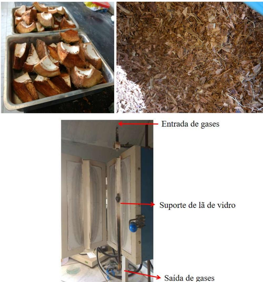
Figura 12. (a) Cascas de coco *in natura* e (b) cascas secas e trituradas (c) cascas no centro do reator vertical.
