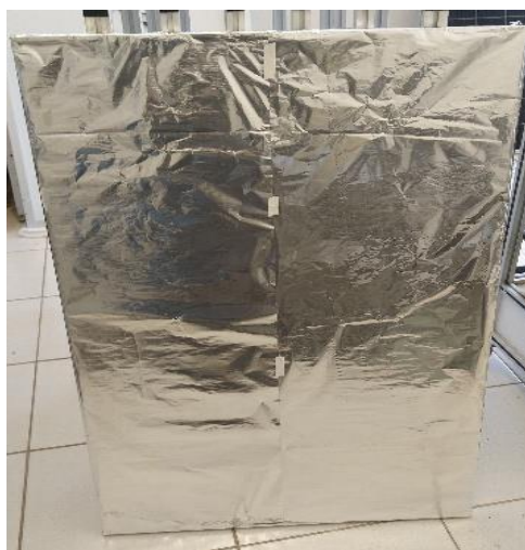
Figura 39 – Superfície fotoativa do módulo coberta com papel alumínio.
