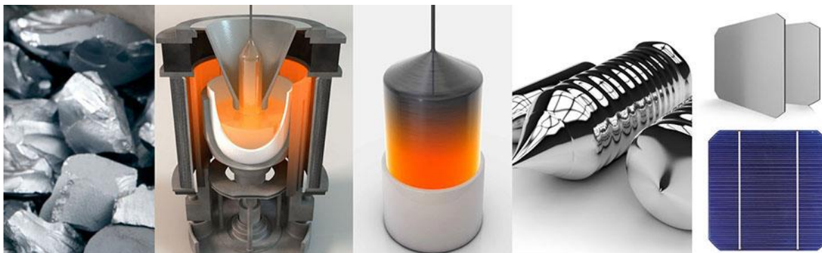
Figura 12 – Etapas da produção do silício monocristalino.
