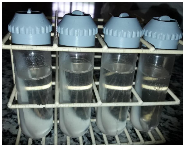
Figura 4.4. Fotografia da dispersão coloidal de óxido de zinco após o processo de centrifugação.
