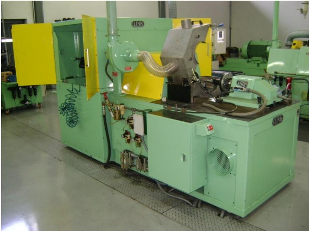
Figura 2.16 - Dinamômetro em Escala da Fras-le ( Fras-le Scale Dynamometer - FSD )
