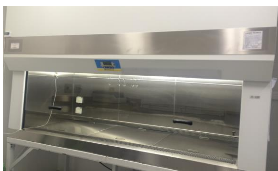
Figura 5. Cabine de Segurança Biológica (CSB), classe II, tipo B2 (NESS, 2018).
