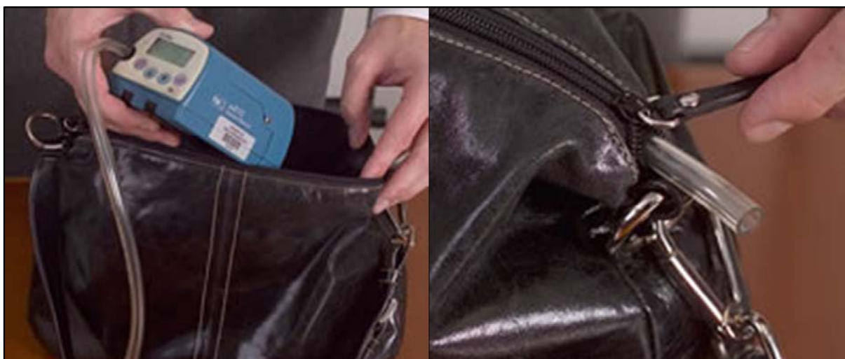
Figura 5.2 — Monitor para coleta de partículas finas [RPCI, 2008]
