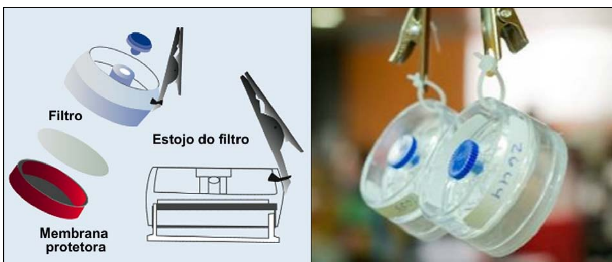
Figura 5.1 — Filtro para coleta de nicotina [JHSPH, 2009c (Adaptado)]
