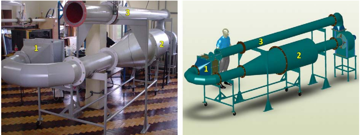
Figura 5.10 — Bancada de ensaios de elementos filtrantes para material particulado (1 primeiro filtro, 2 segundo filtro, 3 pontos de aquisição)
