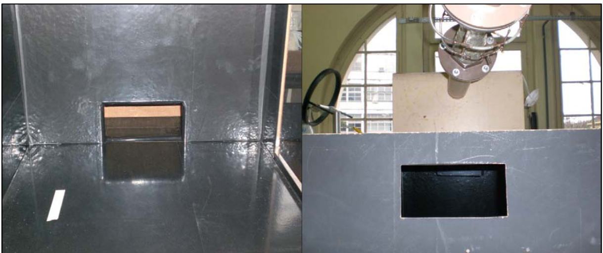
Figura 4.9 — Aberturas de insuflamento e exaustão
