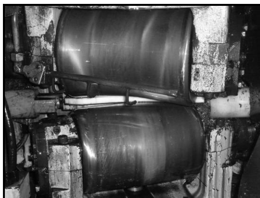
Fig. 3.10 – Rolos de endireitamento
