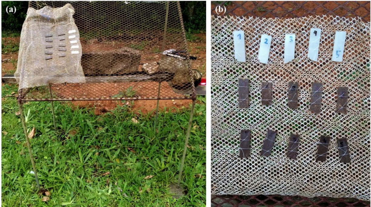
Figura 13 - (a) Estrutura onde foram fixadas as amostras para o monitoramento de intemperismo natural e (b) amostras selecionadas para o ensaio.
