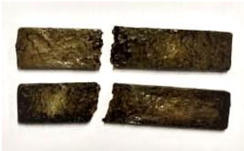
Figura 19 - Rompimento das amostras de PLA/EF após ensaio de compostagem.
