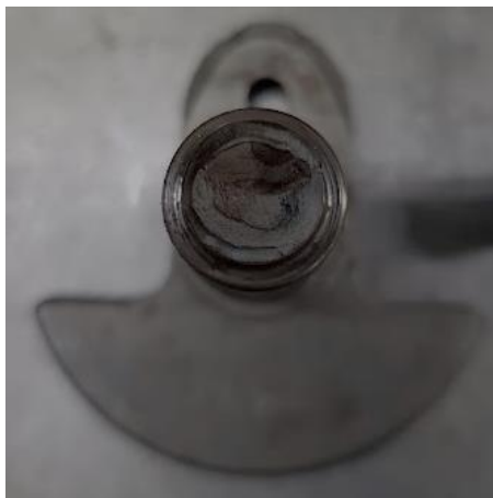
Figura 32 – Fratura do virabrequim após ensaio de flexão rotativa.
