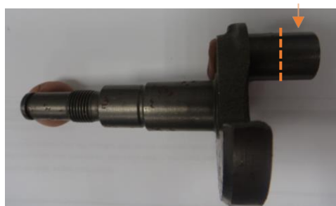
Figura 10 – A seta em laranja indica o local de retirada da amostra para práticas metalográficas.
