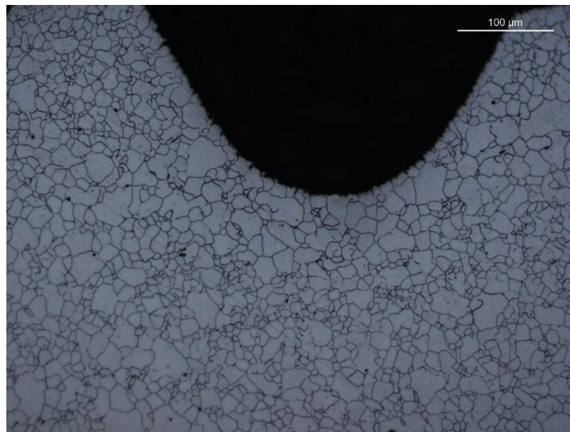
Figura 30 – Heterogeneidade no tamanho de grão no fundo de rosca. Aumento de 200x. Ataque: Picral.
