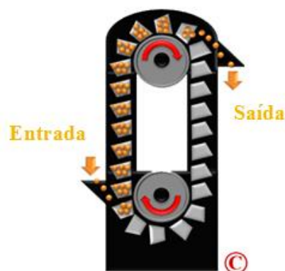
Figura 1 - Esquema representativo de um elevador de canecas.
