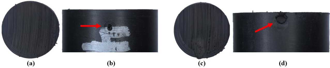
Figura 20 - Fusão localizada ocorrida no ensaio C: (a) V=1,4 m/s, vista superior da face atritada; (b) V=1,4 m/s, vista frontal; (c) V=1,5 m/s, vista superior da face atritada; (d) V=1,5 m/s, vista frontal.
