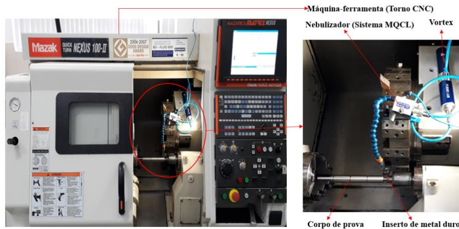
Figura 4 – Disposição da máquina e equipamentos utilizados no experimento.
